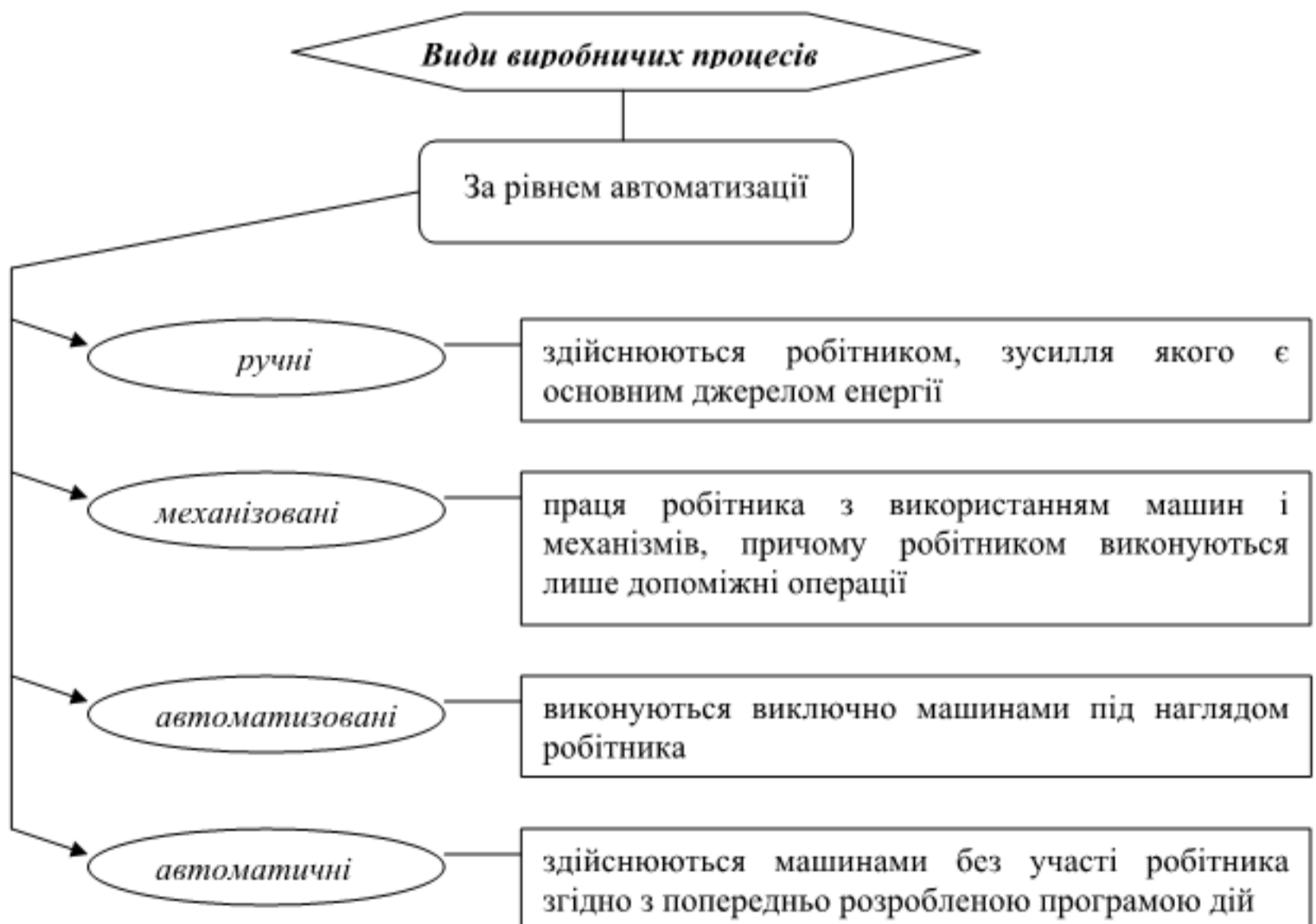
Рис. 10.5.4. Види виробничих процесів в залежності від рівня автоматизації
