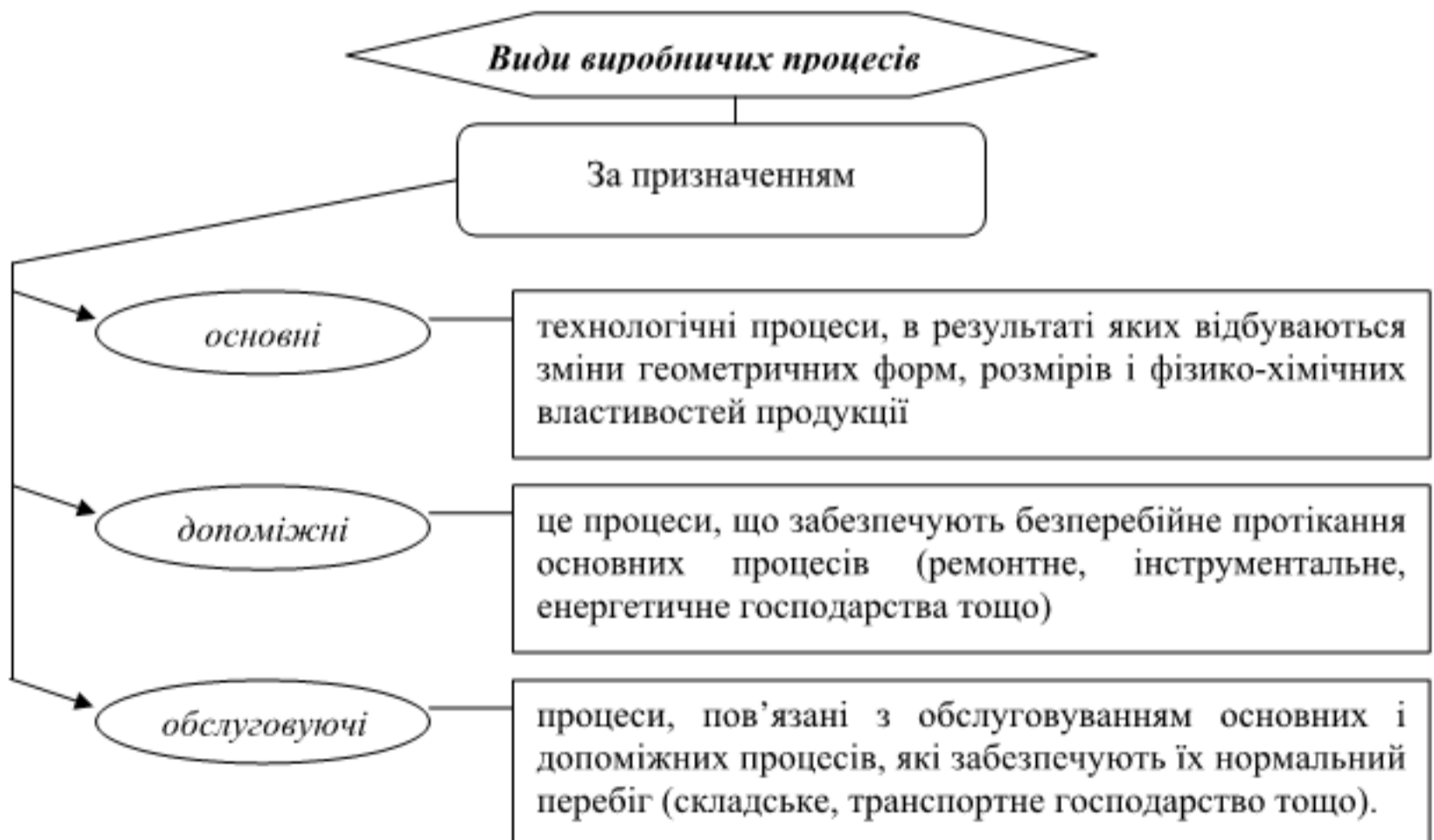
Рис. 10.5.2. Види виробничих процесів в залежності від призначення
