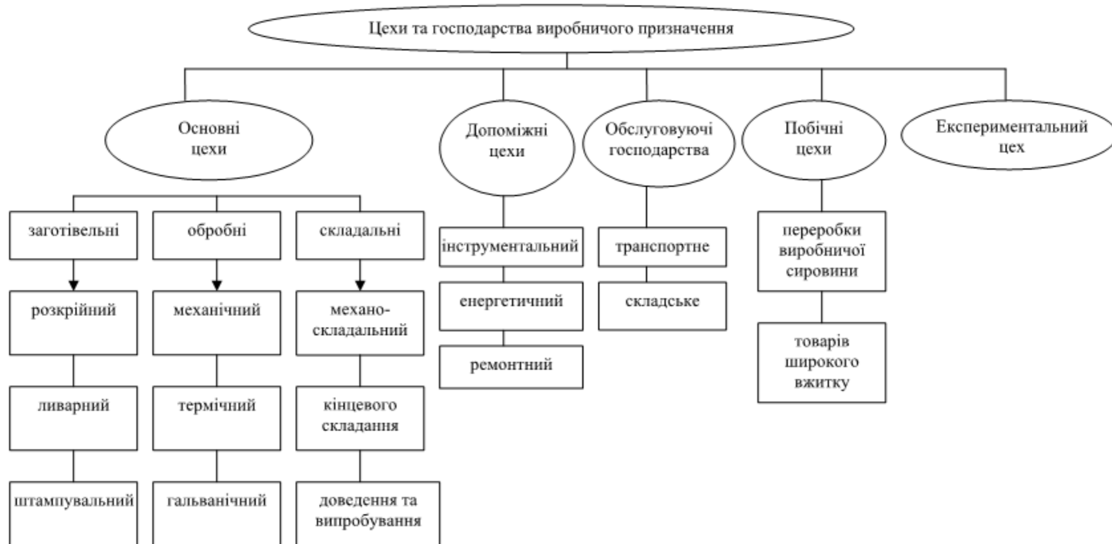
Рис. 2.1.8. Схема виробничої структури машинобудівного виробництва
