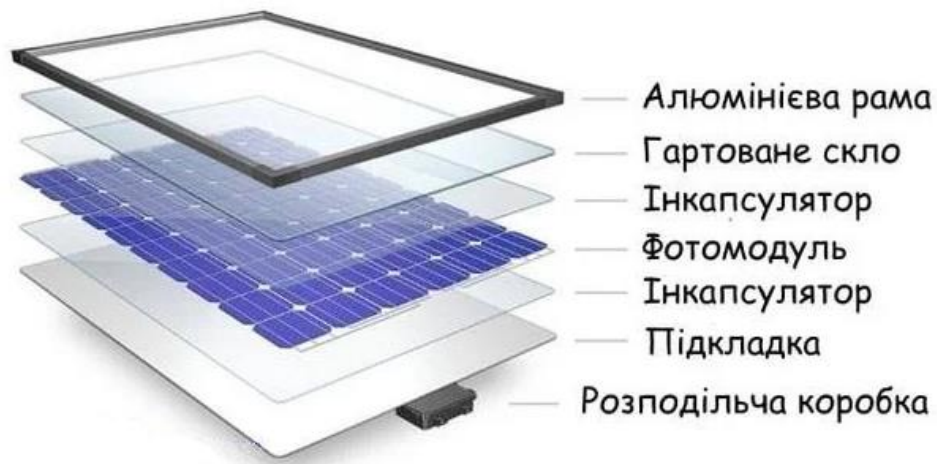
Рисунок 9.4 – Будова сонячної панелі на основі кристалічних кремнієвих ФЕП
