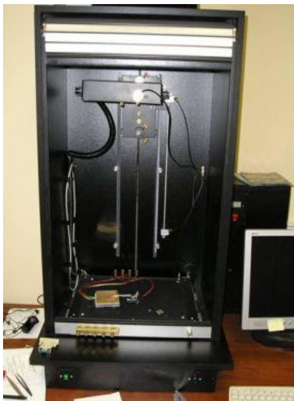
Рисунок 4.2 – Імпульсний імітатор сонячного випромінювання «Техноексан» з діапазоном ступенів концентрації світлового потоку від 1 до 1000
