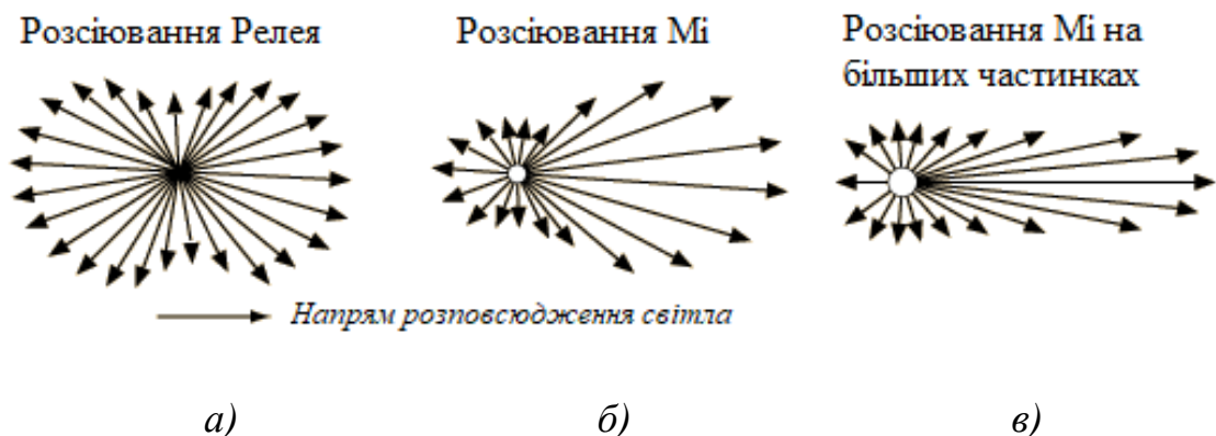
Рисунок 1.4 – Просторовий перерозподіл напрямків розповсюдження світла в результаті розсіювання: а – розсіювання Релея; б, в – розсіювання Мі
