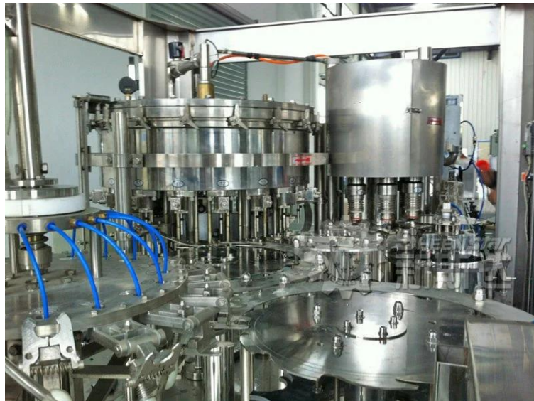
Рис. 24 Машина розливу із середини, основний матеріал виготовлення, нержавіюча сталь.
