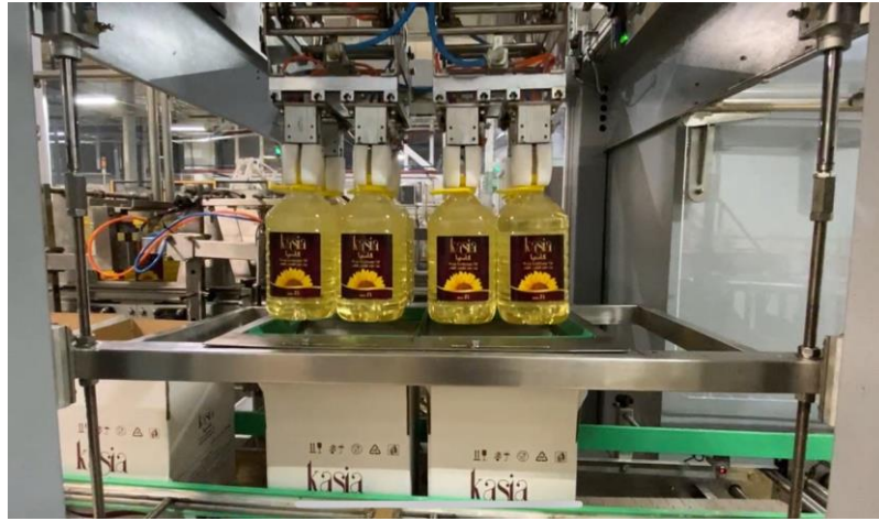
Рис. 20 Укладка пляшок в короба
