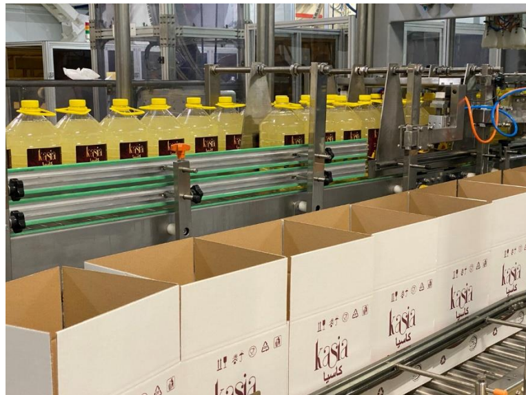
Рис. 19 Подача коробів та пляшок
