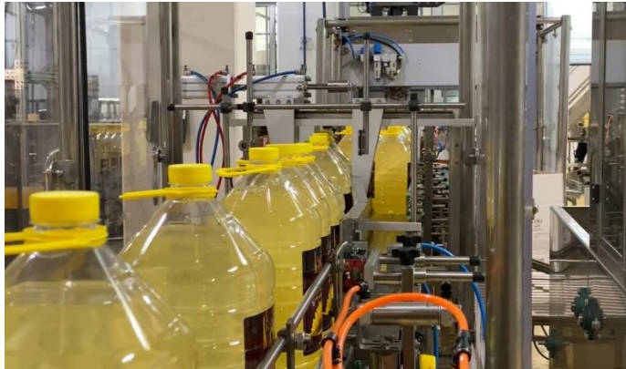
Рис. 18 Рух пляшок по розподільчому блоці
