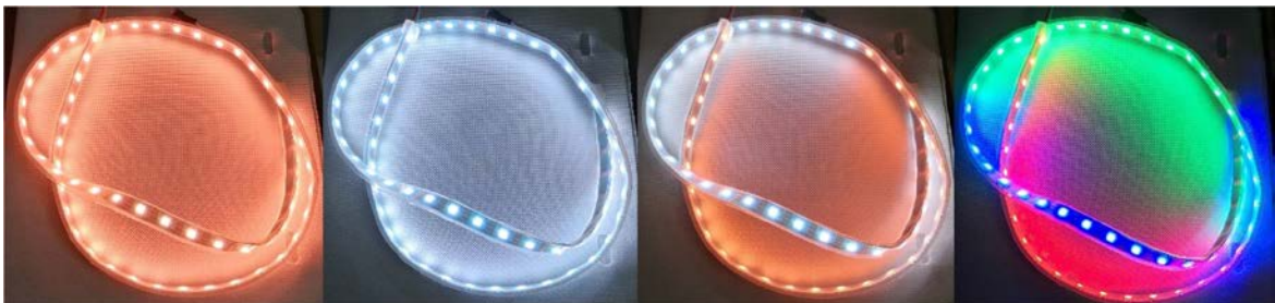
Рисунок 3.8 – Світлодіодна стрічка освітлення, що створює змінні тони кольорів
