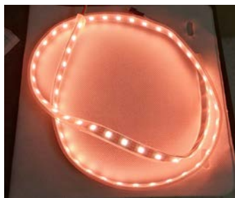
Рисунок 3.9 – Світлодіодна стрічка освітлення, що виробляє 4148 К ССТ
