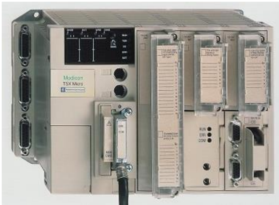
Рисунок 2.1 – Контролер TSX Micro 3721
