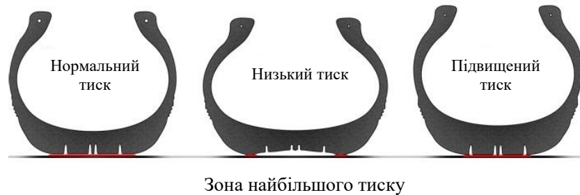
Рис. 1.10. Пляма контакту шини з поверхнею в залежності від тиску в ній [22]
