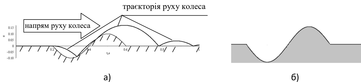
Рис. 3.6. Відскок колеса на перешкоді (а), геометрія перешкоди (б)
