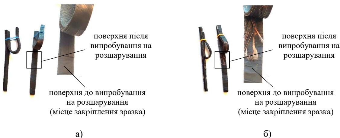
Рис. 3.18. Розшарування зразків і поверхня руйнування на межі «гума-волокна металевих кордунів» (а), поміж волокон кордунів (б)
