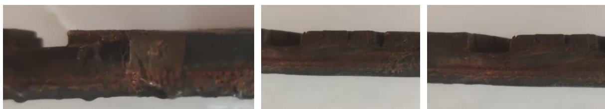
Рис. 4.26. Корозійне пошкодження пневматичної шини під дією засобів технічного очищення дорожнього покриття (поперечний переріз)
