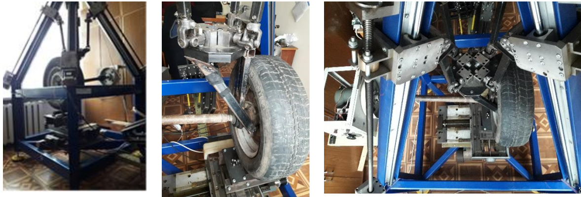
Рис.3.2. Чотирикоординатний стенд для випробування лабораторних властивостей пневматичних шин з програмно керованим управлінням [85]
