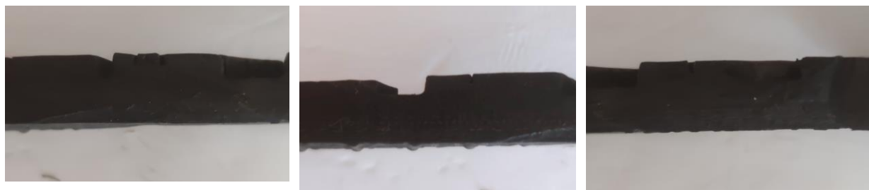
Рис. 4.24. Вплив мастильних речовин на пошкодження гумо-кордної конструкції (поперечний переріз)
