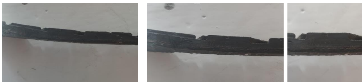
Рис. 4.25. Вплив поверхнево активних речовин на корозійну руйнацію пневматичної шини (поперечний переріз)
