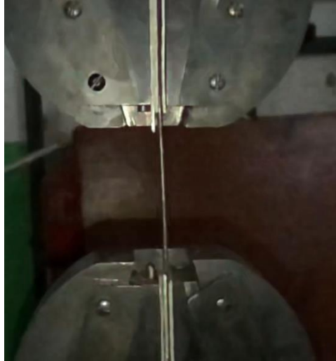
Рис. 4.11 Закріплення дроту в затискачах розривної машини. Альтернативна пропозиція для визначення відносного подовження дроту.
