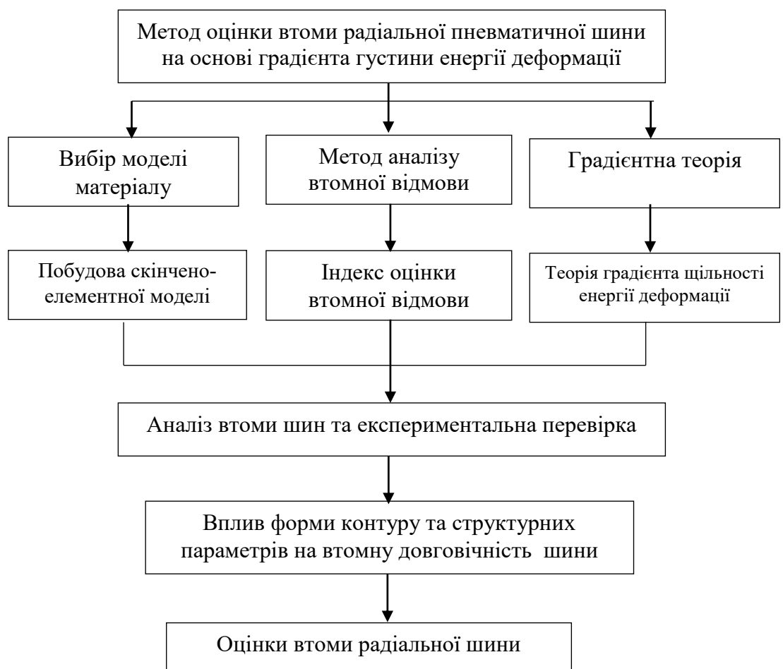
Рис. 4.1. Метод оцінки втоми радіальної пневматичної шини на основі градієнта густини енергії деформації [11]
