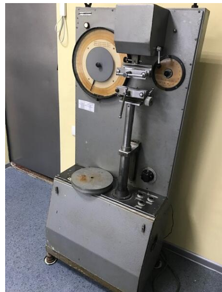
Рис. 2.4. Обладнання для випробування шин на розтяг і розшарування матеріалів: а)- машина універсальна розривна Р-5 УХЛ 4.2; б)- машина розривна типу РТ-250М
