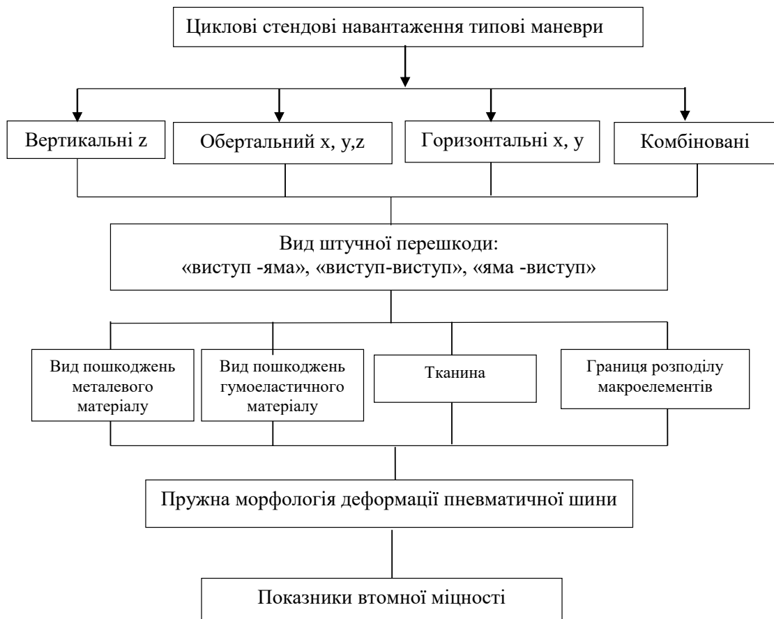
Рис.4.4. Блок схема послідовності визначення змін втомної міцності при стендових випробуваннях радіальної пневматичної шини
