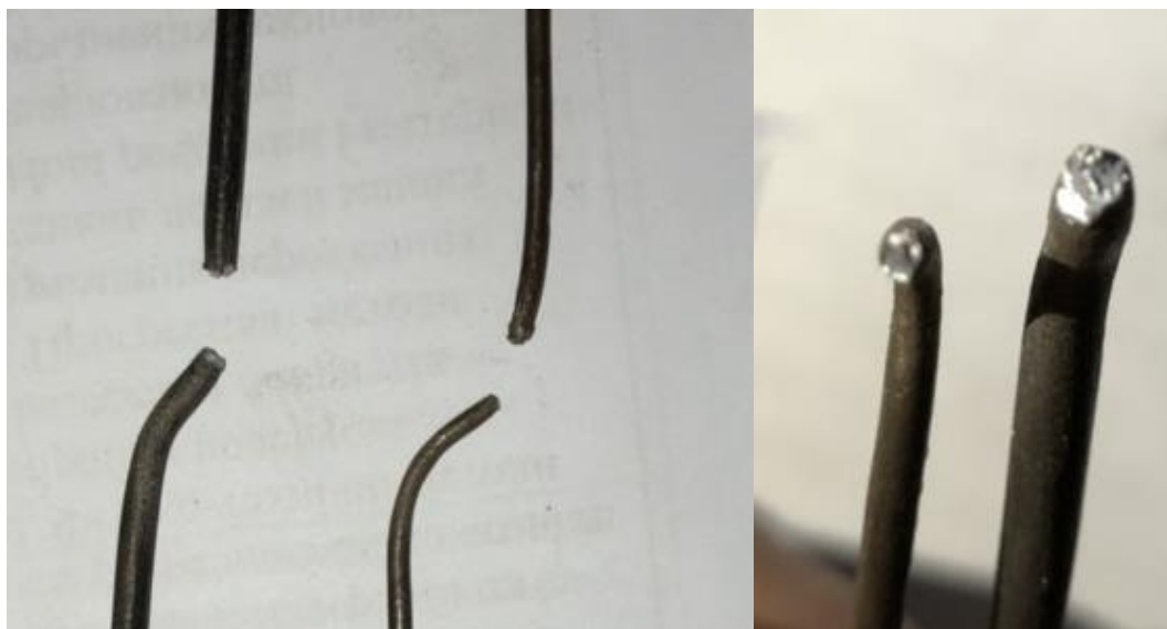
Рис 4.17 Зруйновані при перегині зразки
