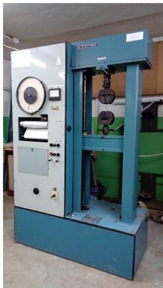
Рис. 2.4. Обладнання для випробування шин на розтяг і розшарування матеріалів: а)- машина універсальна розривна Р-5 УХЛ 4.2; б)- машина розривна типу РТ-250М
