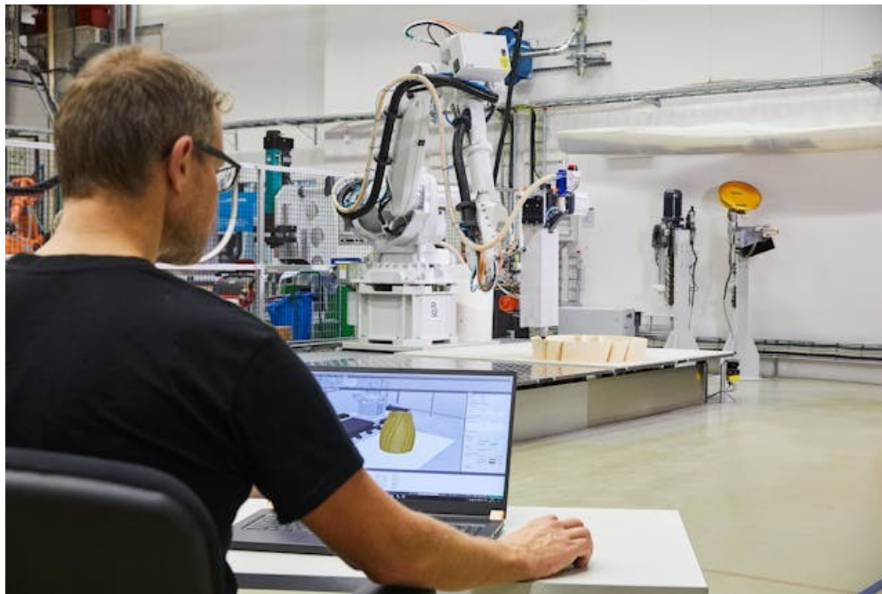
Рисунок 3.14 – Керування роботами через симуляцію в програмі RobotStudio
