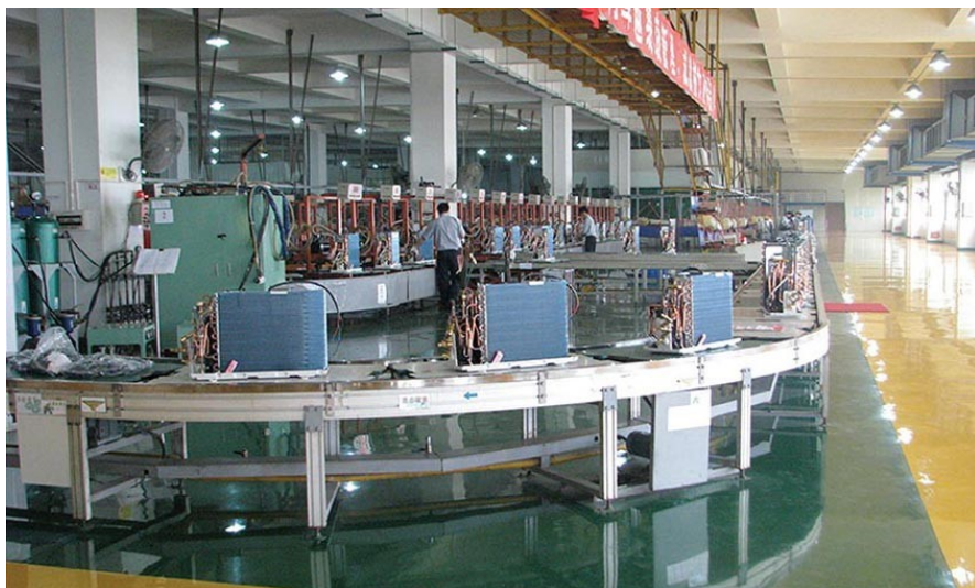
Рисунок 2.8 – Конвеєрна лінія складання компресора та радіатора зовнішнього блоку
