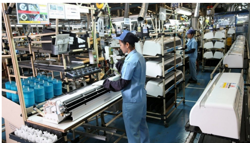
Рисунок 2.7 – Виробничий процес складання корпусу кондиціонера
