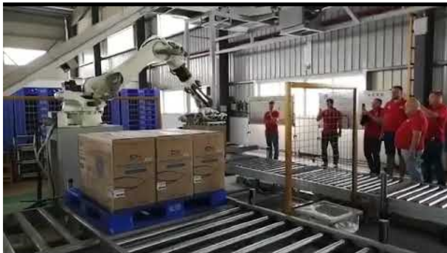
Рисунок 2.16 – Процес пакування готової продукції за допомогою роботів
