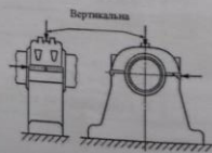
Рисунок 2.1а - Точки вимірювання на опорі підшипника
