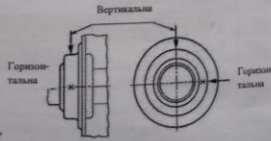
Рисунок 2.1б - Точки вимірювання на корпусі підшипника
