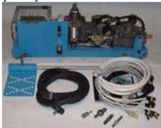
Рис. 5.1 Стенд для перевірки форсунок автомобільних газопаливних систем.
