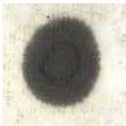
Рис. 5 Робоче мастило в задовільному стані
