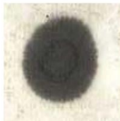
Рис. 6 Робоче мастило в критичному стані
