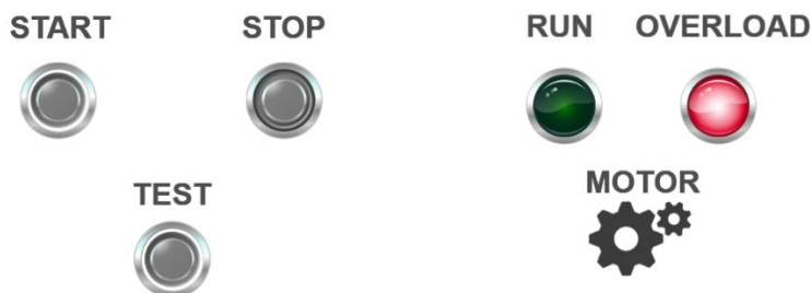
Рисунок 10 – Схема після натискання кнопки TEST(у процесі OVERLOAD)
