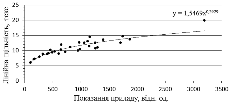
Рисунок 2 – Зв'язок показань приладу з лінійною щільністю лляного волокна
