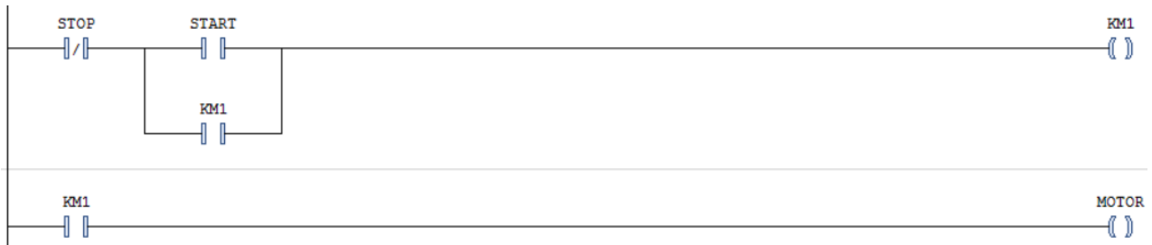
Рисунок 2 – LD схема підключення магнітного пускача (не реверсивна схема)
