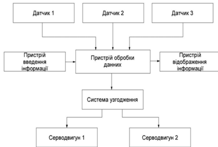
Рисунок 5 – Схема структурна трекера з диференційним вимірюванням
