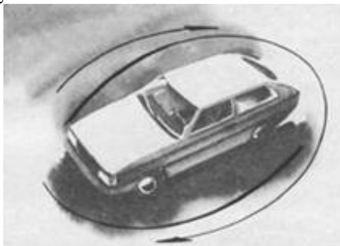
Рис. 14.4 - Рух автомобіля при аварійному гальмуванні обертанням
