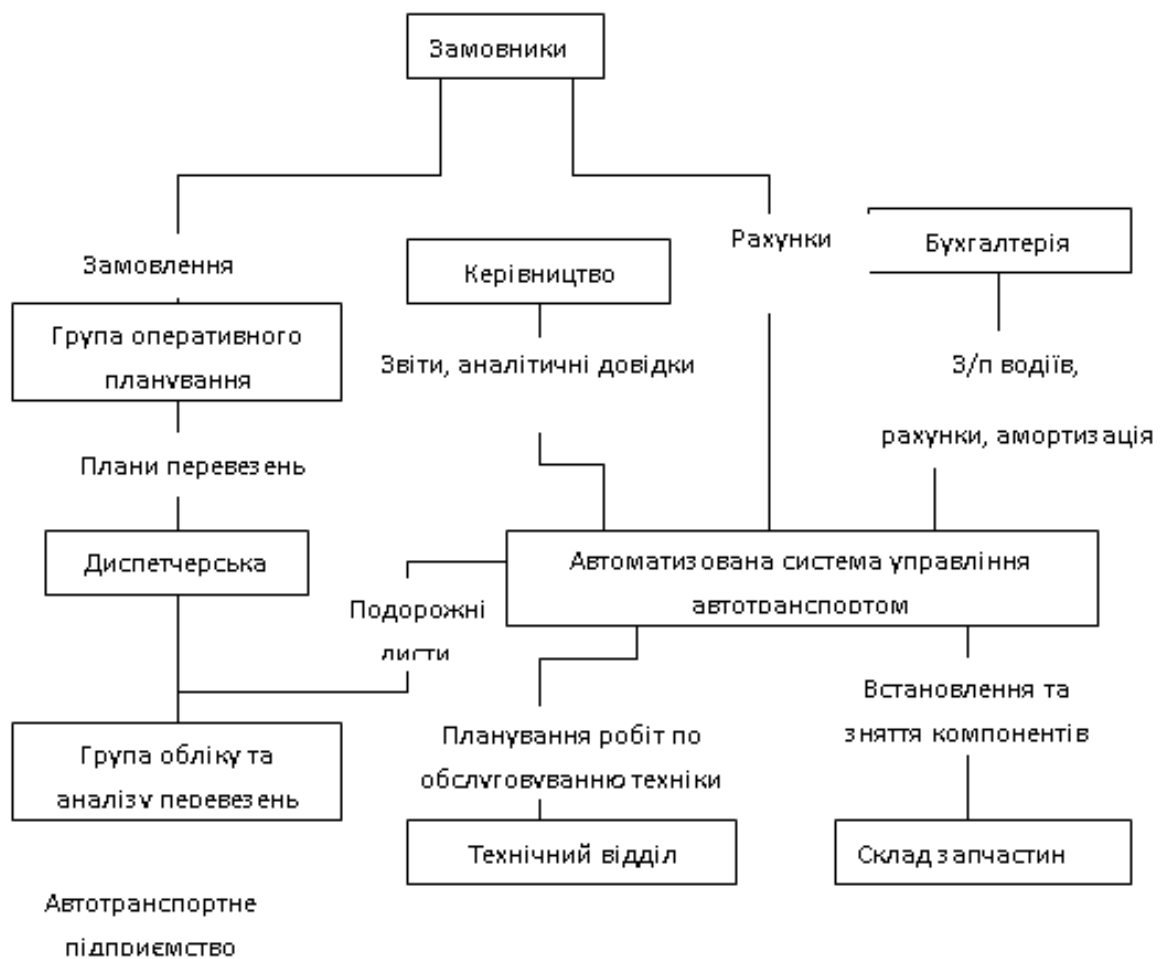
Рис 9.1 - Схема основних інформаційних потоків при управлінні автотранспортом
