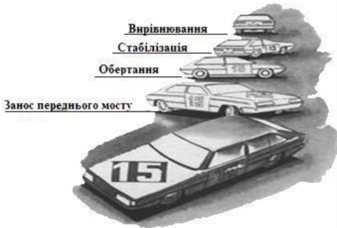
Рис.13.6 - Подолання серії імпульсів ритмічного заносу
