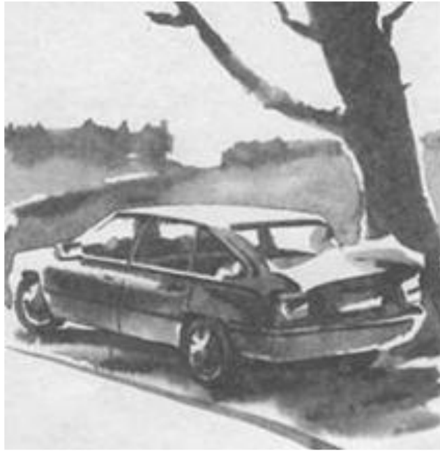
Рис. 14.5 - Момент ковзаючого удару об перешкоду при аварійному контактному гальмуванні
