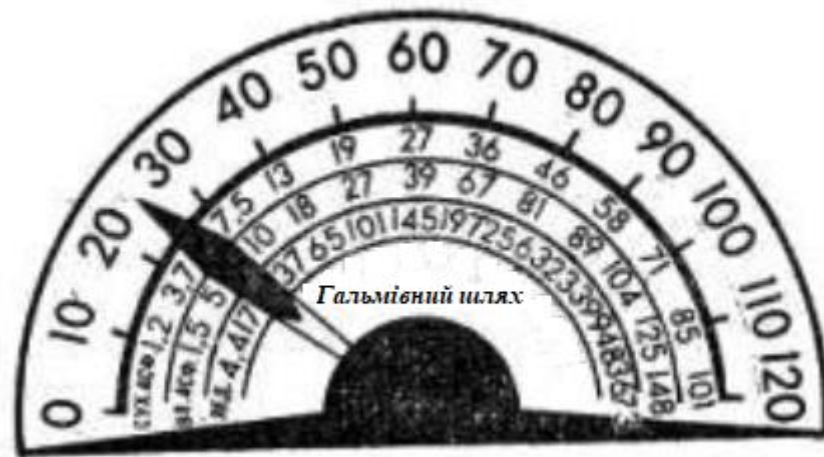
Рис. 12.6 Діаграма визначення гальмівного шляху легкового автомобіля в залежності від швидкості руху і стану покриття дороги
