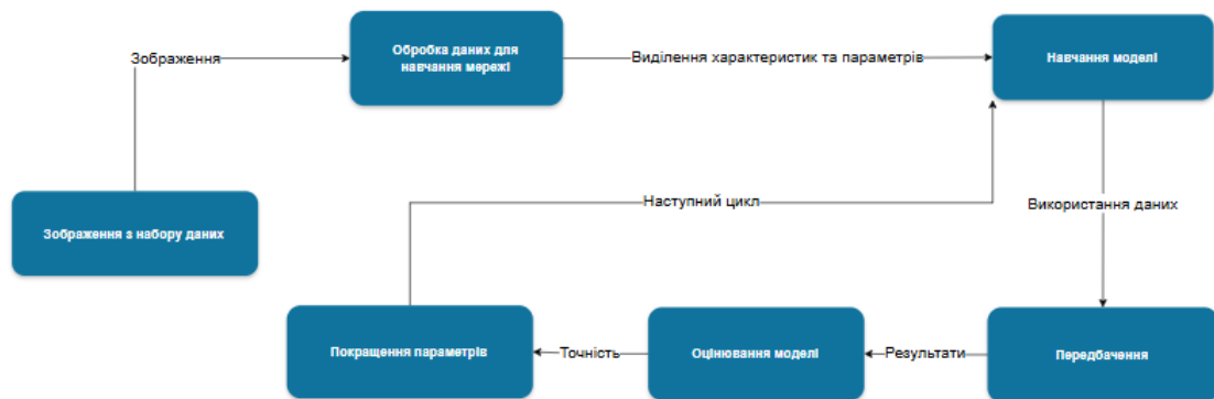
Рис. 2.5. Схема роботи згорткової нейронної мережі
