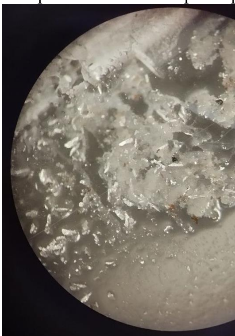
Рис. 3. Кристали лактату цинку під мікроскопом (світлова мікроскопія; збільшення 32х)
