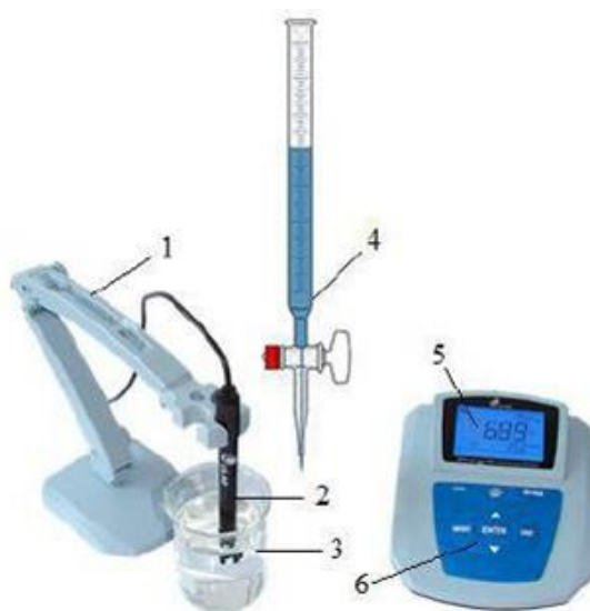
Рисунок – Схема кондуктометра лабораторного МР 521:
