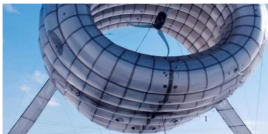
Рисунок 3 – Надувний аеростат трубчастого типу з крильчаткою генератора
