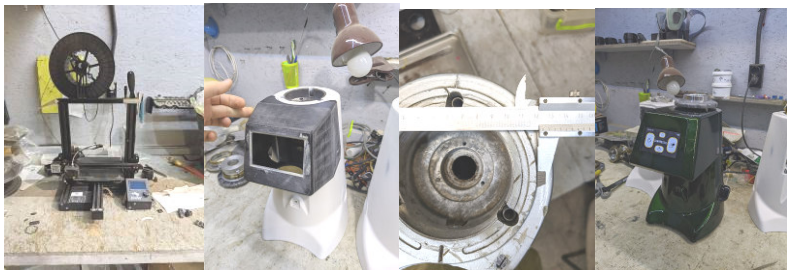
Рис. 1. Друк і складання корпусу дослідного зразка кавомолки автомату
