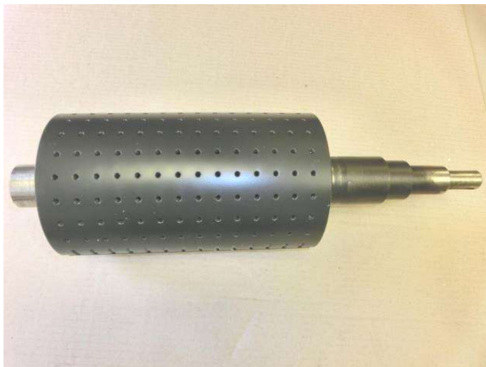
Рис. 1. Ножовий барабан етикувального автомату фірми KHS (Німеччина) з нанесеним фторопластовим покриттям на основі фторполімеру Ф-30П підприємства ПрАТ "Оболонь Красилівське", м. Красилів, Хмельницька область.
