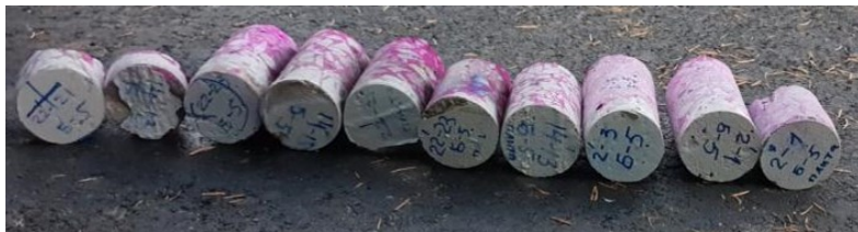
Рис. 2. Загальний вигляд групи вибурених кернів з тіла бетону балок прогонової будови для оцінки карбонізації
