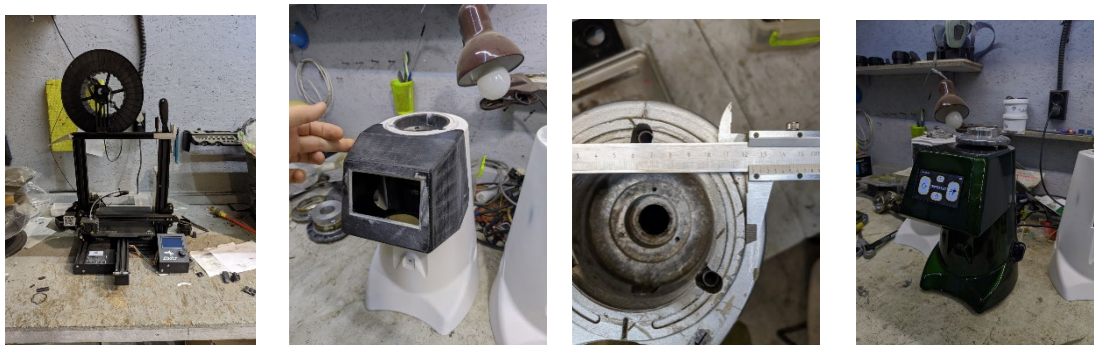
Рисунок 1 – Друк і складання корпусу дослідного зразка кавомолки автомату
