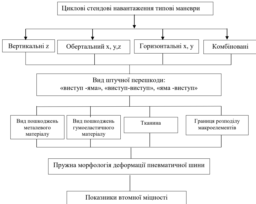
Рисунок 3 – Блок-схема послідовності визначення змін втомної міцності при стендових випробуваннях радіальної пневматичної шини
