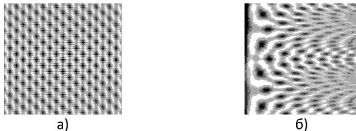
Рисунок 2 – Автокореляційна функція а) для зображення тканини, б) у полярних координатах
