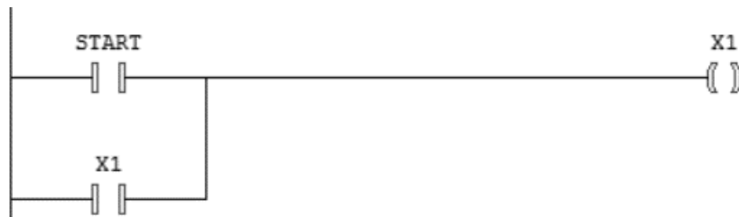
Рисунок 2 – LD схема з кнопкою пуску, механізмом збереження значення (X1) та контактором (X1)
