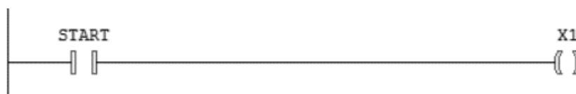
Рисунок 1 – LD схема, що складається з кнопки (START) та контактора (X1)
