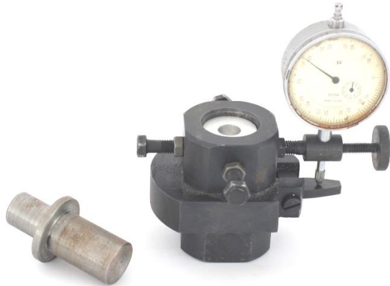
Рисунок 1 – Пристрій для дослідження величини пружно-пластичної зони
