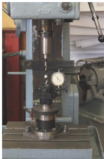
Рисунок 3– Експериментальна установка для дослідження величини пружно-пластичної зони
