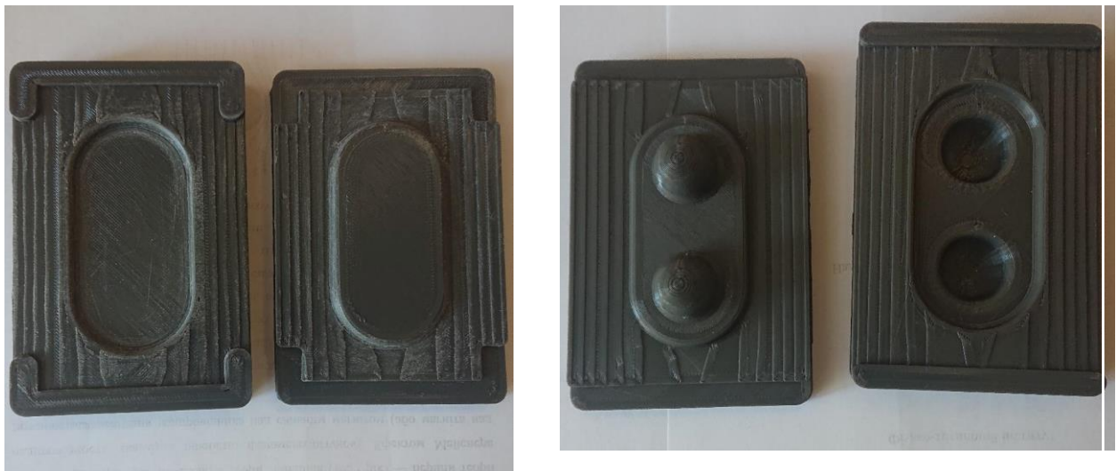
Рисунок 1. Надруковані інструменти для першого та другого переходу
