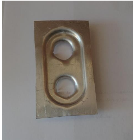
Рисунок 2. Зразок деталі після операцій формування
