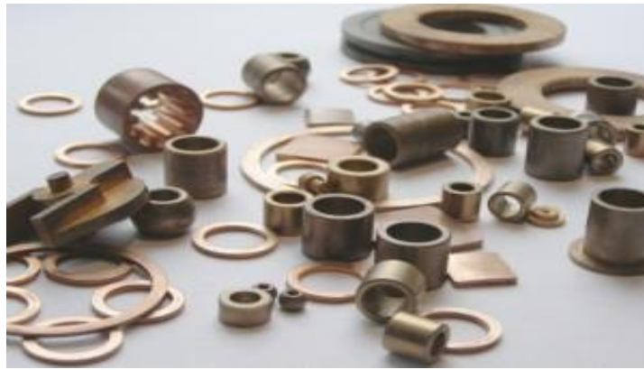
Рисунок 5 – Партія напрямних втулок, підшипників ковзання виготовлених із композиційного матеріалу на основі порошку сталі ШХ15
