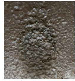
Рисунок 10 – Фотографія поверхні зразка з модельним забрудненням після оброблення пульсуючим струменем рідини металевими кульками, кут 125^0
