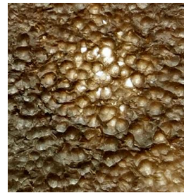
Рисунок 9 – Фотографія поверхні зразка з модельним забрудненням після оброблення пульсуючим струменем рідини металевими кульками, кут 90^0
