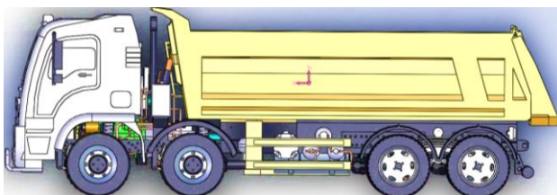
Рисунок 5. Скріншот виду з боку складного рухомого об'єкта з навантаженням (ґравій) та результати визначення маси та координат центру ваги
