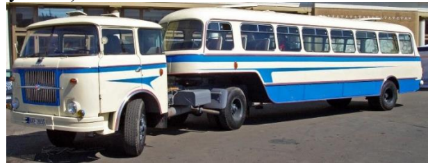
Рисунок 1 – Аеродромні автобуси 50-60 років минулого століття: а) сідловий тягач Ford з пасажирським напівпричепом, що використовувався в аеропорту Цюриха; б) вантажівка Skoda з напівпричепом на базі автобуса Skoda.
