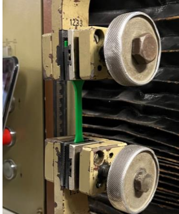
Рис. 2. Зразок з PLA в затискачах установки
