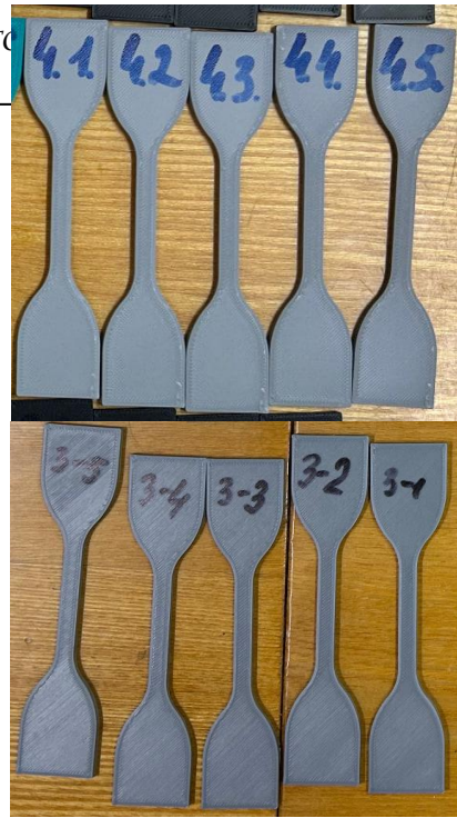
Рисунок 3 – Загальний вигляд дослідних зразків матеріалів, надрукованих методом 3D-друку: зразки 3.1...3.5 виготовлені з PLA виробництва Gembird (Нідерланди); зразки 4.1...4.5 виготовлені з PLA виробництва Devil Design (Польща).
