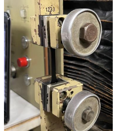
Рис. 4. Зразок з PLA-CF в затискачах установки
