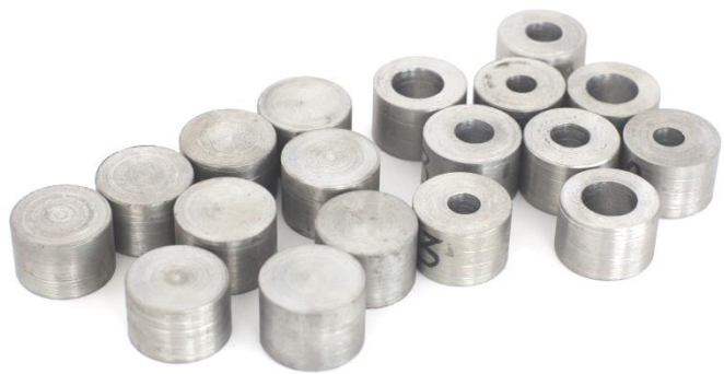
Рисунок 2 – Зразки для дослідження величини пружно-пластичної зони
