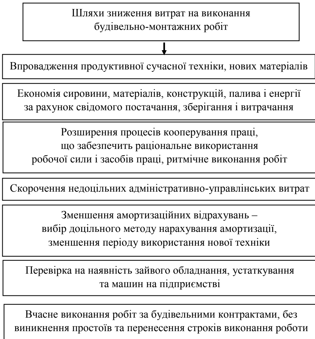
Рис. 9.3. Шляхи зниження витрат на виконання будівельно-монтажних робіт*
