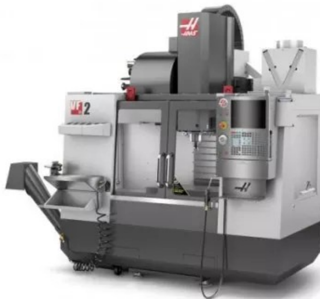
Рис 3. Загальний вид вертикально-фрезерного верстату с ЧПУ HAAS VF-2 Технічні характеристики верстата моделі вертикально-фрезерного верстату с ЧПУ HAAS VF-2
