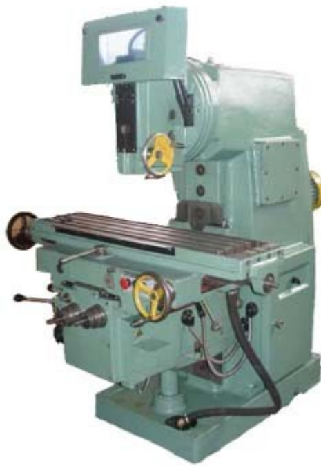
Рис 2. Загальний вид вертикально-фрезерного верстата моделі 6P13.
