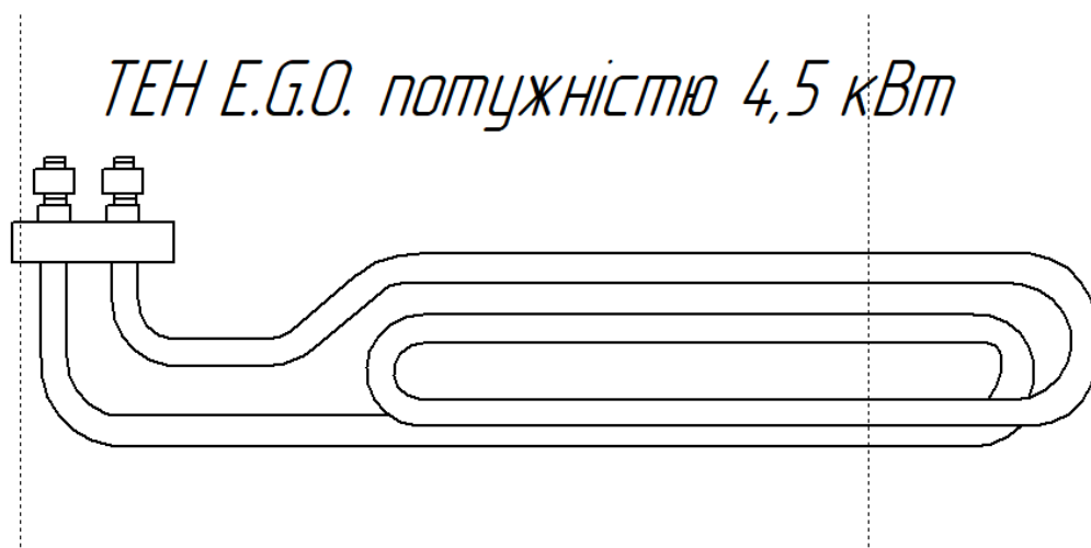
Рисунок 13. ТЕН E.G.O. Сучасний енергоефективний ТЕН, нержавійка, з фланцем
