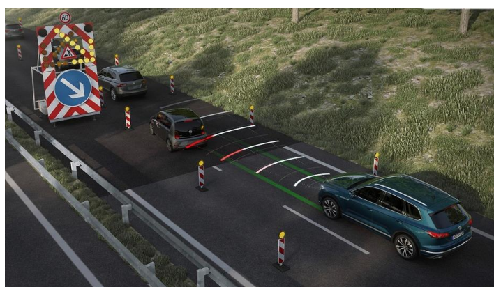
Рисунок 1.10 - Візуалізація визначення відстані до перешкоди системою адаптивного круїз-контролю
