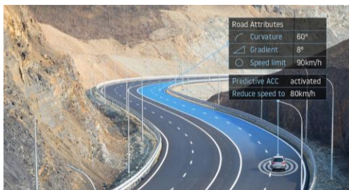
Рисунок 1.11 - Візуалізація роботи системи центрування в смугі
