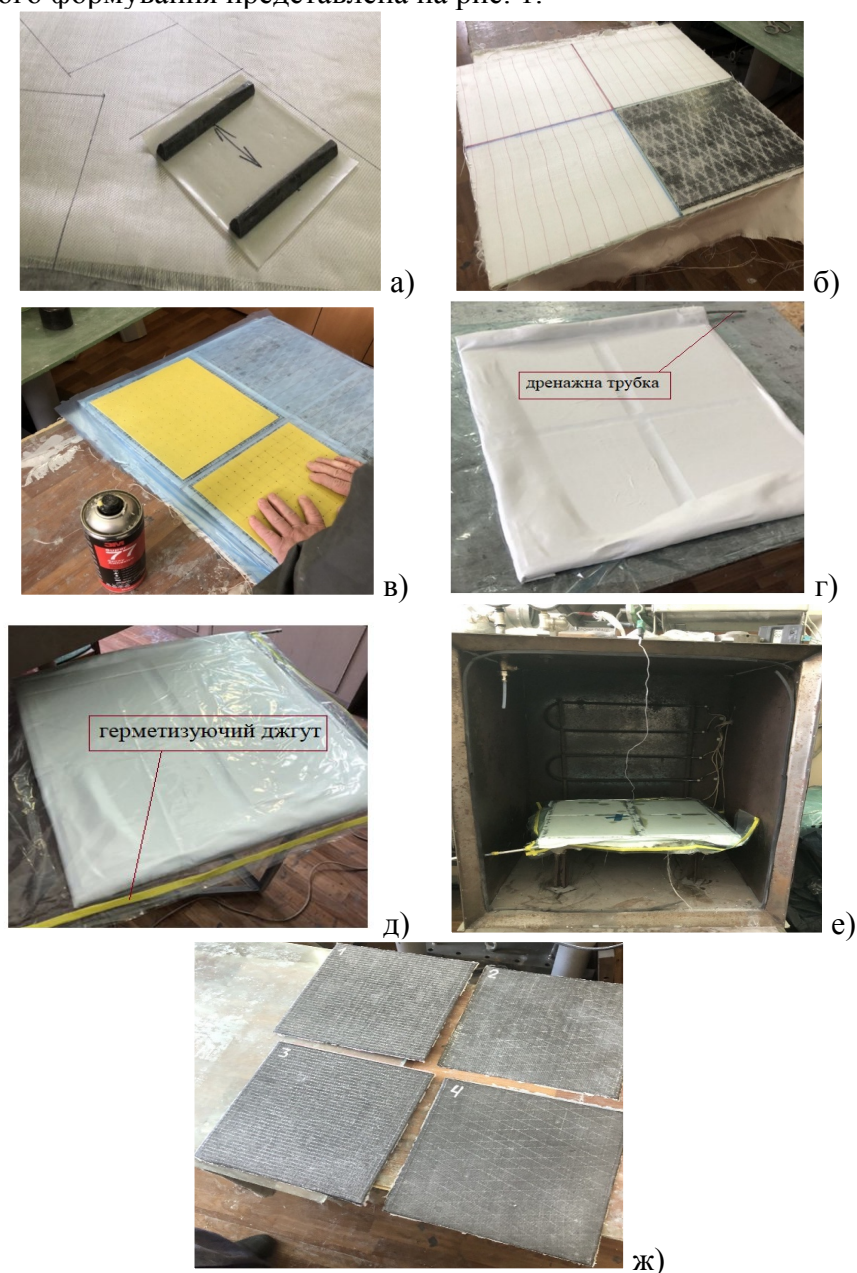
Рисунок 1 – технологічний процес виготовлення гібридного КМ: а) – шаблон для порізки армуючих наповнювачів; б) – укладання шарів скло- та вуглетканини; в) – укладання дренажного склотекстоліту; г) – формування пакету зразків з дренажною
