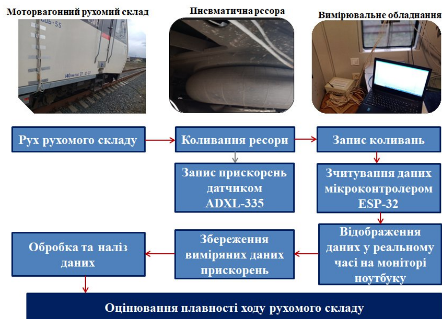
Рисунок 1 – Схема проведення динамічних випробувань моторвагонного рухомого складу
