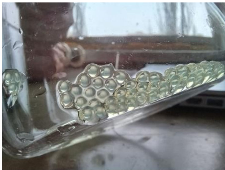
Рисунок 3 – Утворені гідрогелеві сфери (діаметром 3,0 мм) з альгінатним ядром, що містить включення нітрофуралу (фурациліну), покриті колагеновою оболонкою
