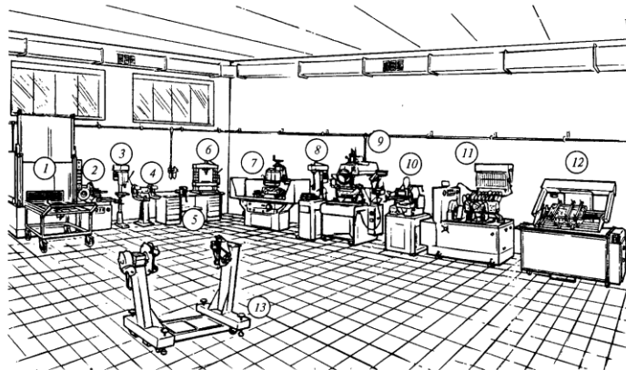
Рис. 5.8. Розміщення технологічного устаткування ділянки ремонту агрегатів автомобіля:
