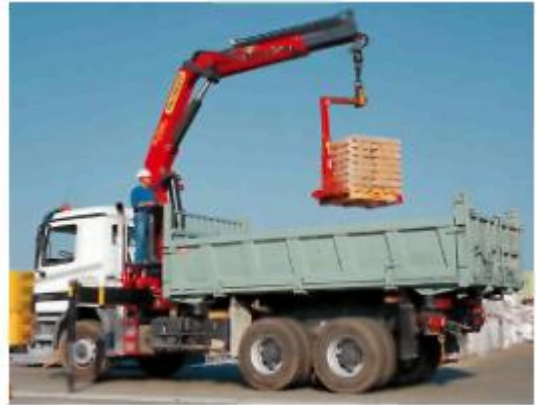
Рис. 2.1.9. Крани-маніпулятори: а) кран-штабелер мостовий; б) бортовий маніпулятор
