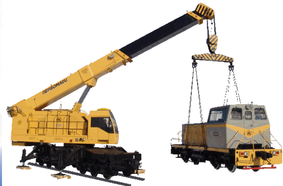
Рис. 2.1.11. Стрілові самохідні крани: а) автомобільний; б) пневмоколісний; в) на спеціальному шасі; г) гусеничний; д) тракторний; е) залізничний
