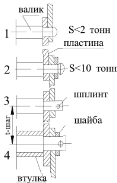
Рис. 7.3. Варіанти пластинчастих ланцюгів
