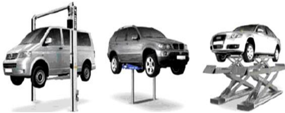
Рис. 4.1 Підйомники з різними опорними пристроями та типом приводу
