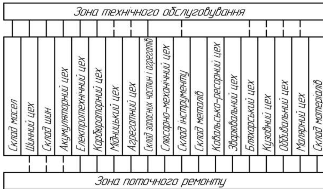
Рис. 2.2 – Зв'язок виробничих дільниць із основними зонами АТП:- зв'язки обов'язкові; - бажані
