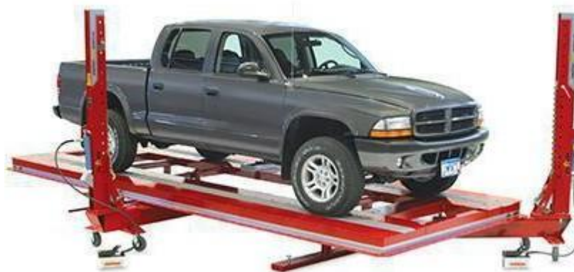
Рис. 8.12 Рамний стенд підлогового виконання для відновлення геометрії кузовів.
