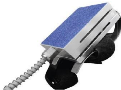
Рис. 5.11 - Пристрій стенду для вимірювання зусилля на педалі гальм.
