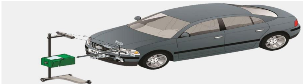
Рис. 5.62 - Орієнтація приладу щодо автомобіля.
