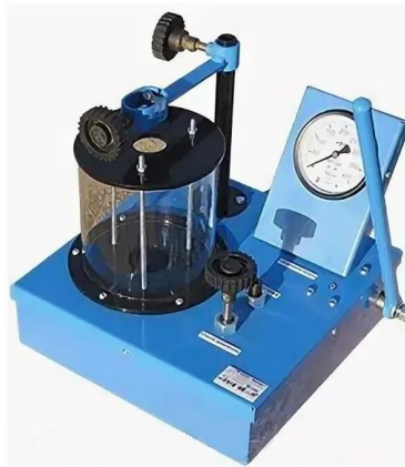
Рис. 5.41 Прилад для перевірки та регулювання механічних форсунок.
