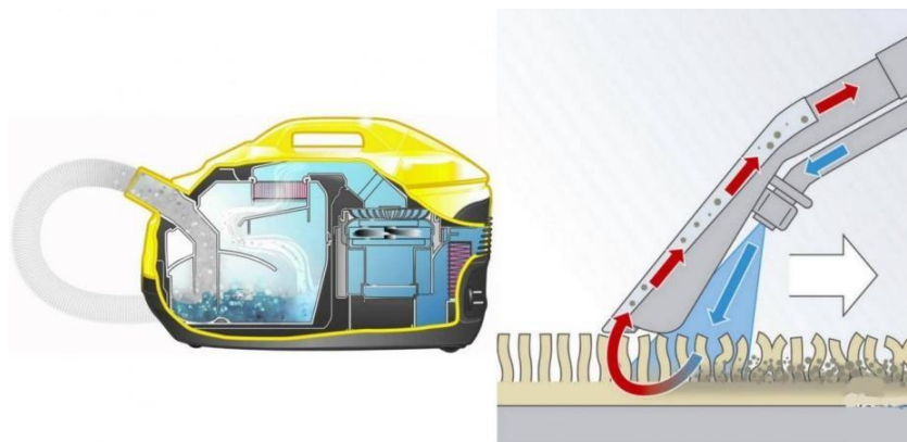
Рис. 2.12 – Будова та принцип дії екстрактора.
