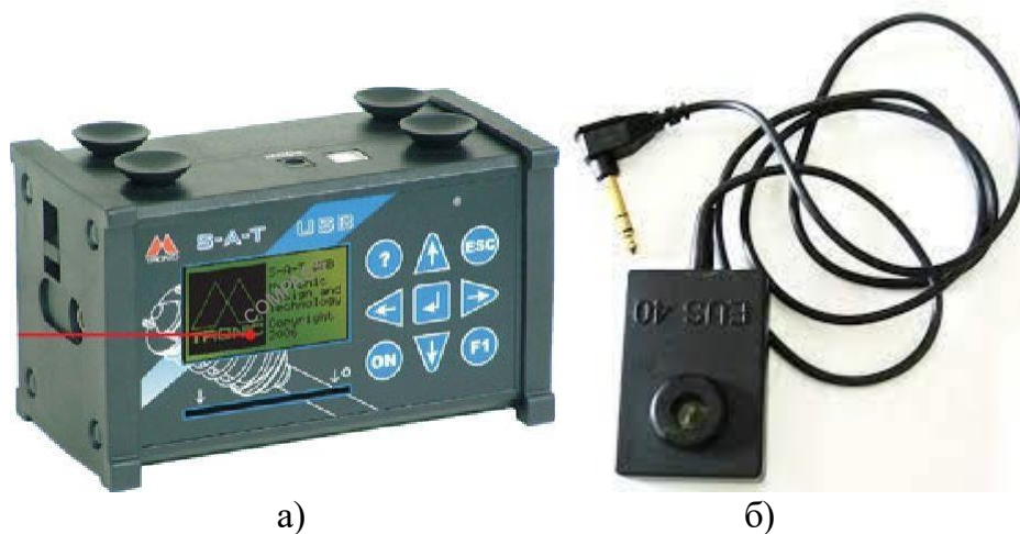
Рис. 5.28 М-Tronic тестер діагностики амортизаторів, S.A.T. (Італія) а – блок; б – джерело ультразвуку
