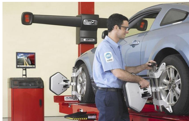
Рис. 5.23 – Робота на станді для контролю кутів встановлення коліс, що працює за 3D-технологією.
