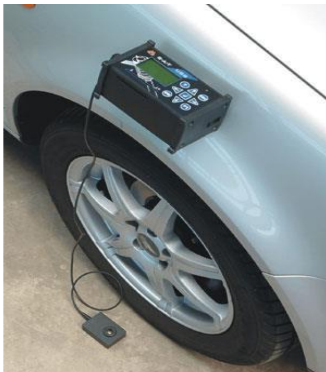
Рис. 5.27 Діагностування підвіски з використання датчика переміщень кузова.
