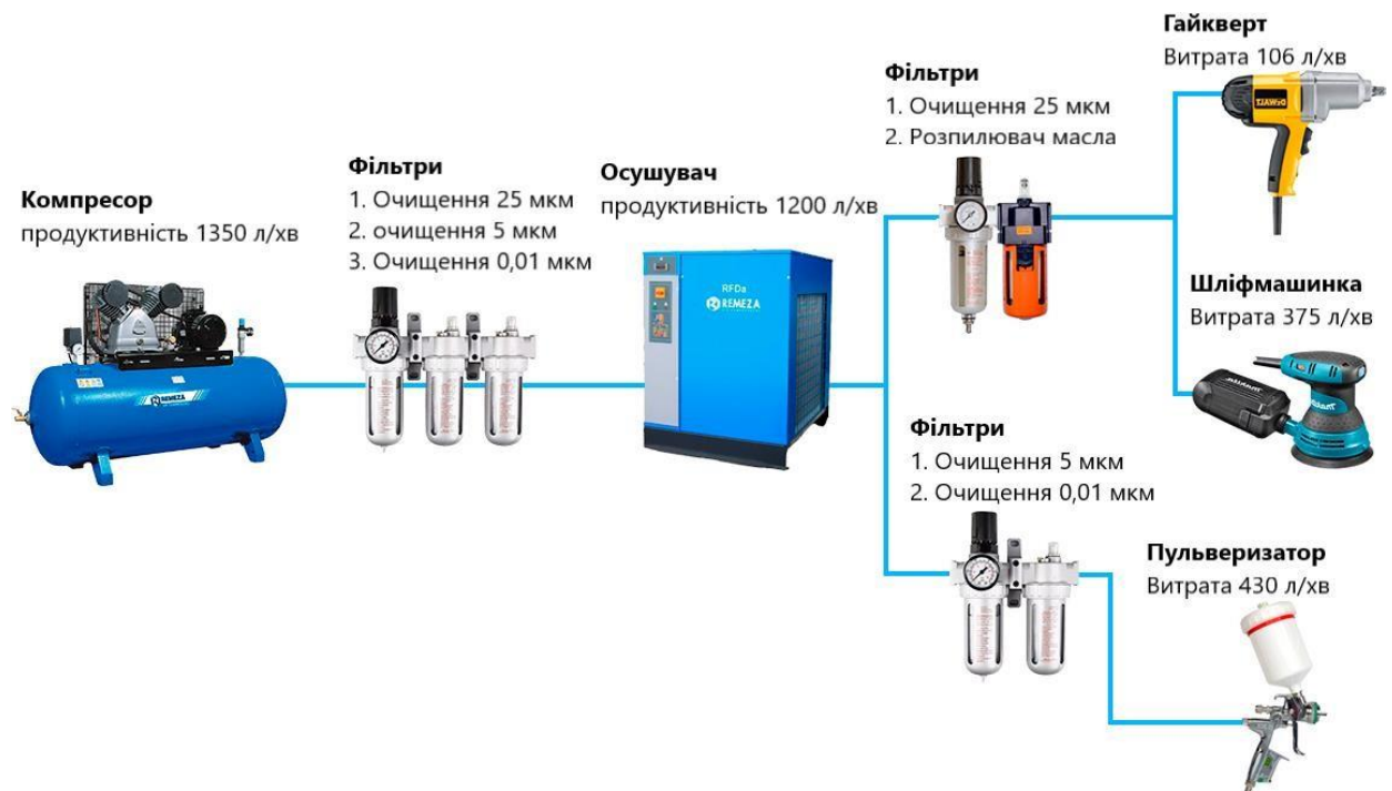
Рис. 4.30 Система підготовки повітря компресорної станції на автопідприємствах.
