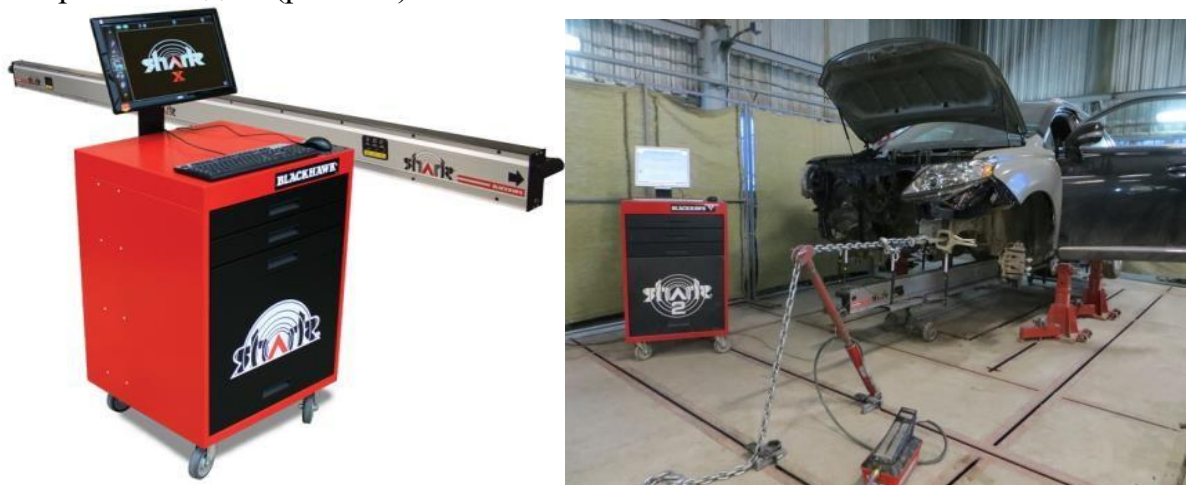
Рис. 8.7 Стенд з вимірювальною системою PMS з комбінованою (ультразвуковою і механічною системою вимірювання в прямокутній системі координат) WEDGE CLAMP SYSTEM (Канада).
