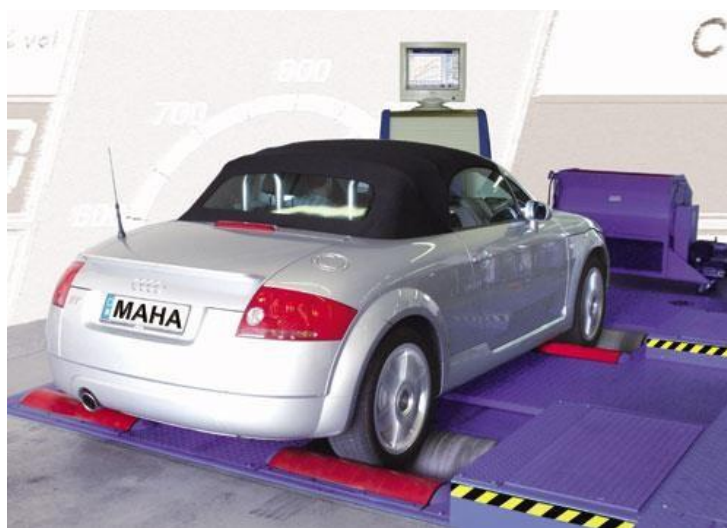
Рис. 5.7 - Динамометричний стенд МАНА (Німеччина) модель LPS 3000
