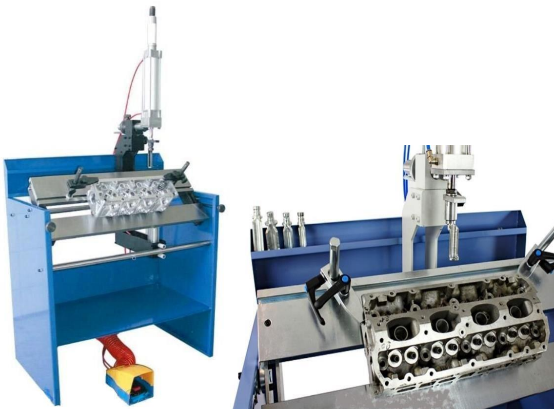
Рис. 7.11 Стенд для розбирання головки блоку циліндрів двигуна.
