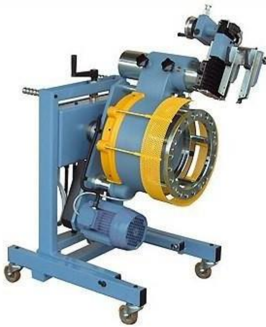
Рис. 7.2 - Верстат TD 502 для проточування гальмівних дисків легкових автомобілів і барабанів коліс мікроавтобусів і невеликих вантажівок без зняття їх з автомобіля фірми COMEC (Італія).
