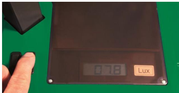
Рис. 5.70 Максимальне значення засліплення \leq 1,0 люкс для галогенного світла, \leq 1,3 люкс для ксенонового світла.
