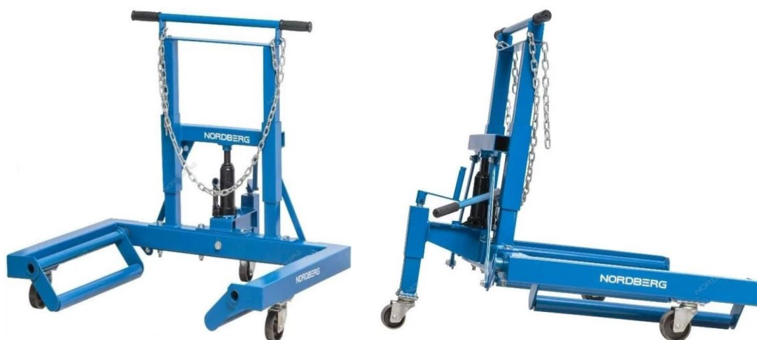
Рис. 3.26 Візок для зняття-установки і транспортування коліс з гідравлічним піднімальним механізмом.
