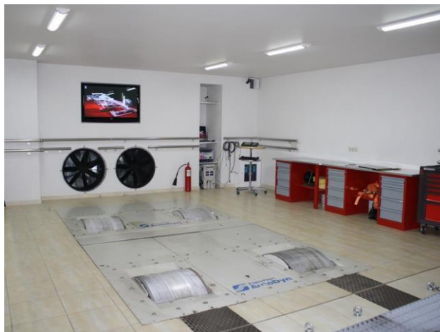
Рис. 5.2 Динамометричний стенд з одинарними біговими барабанами.
