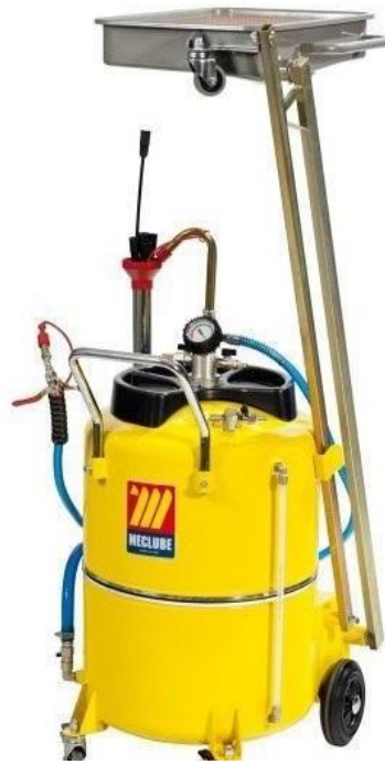
Рис. 4.8 Мастило - збиральник з опусканням воронки до підлоги.
