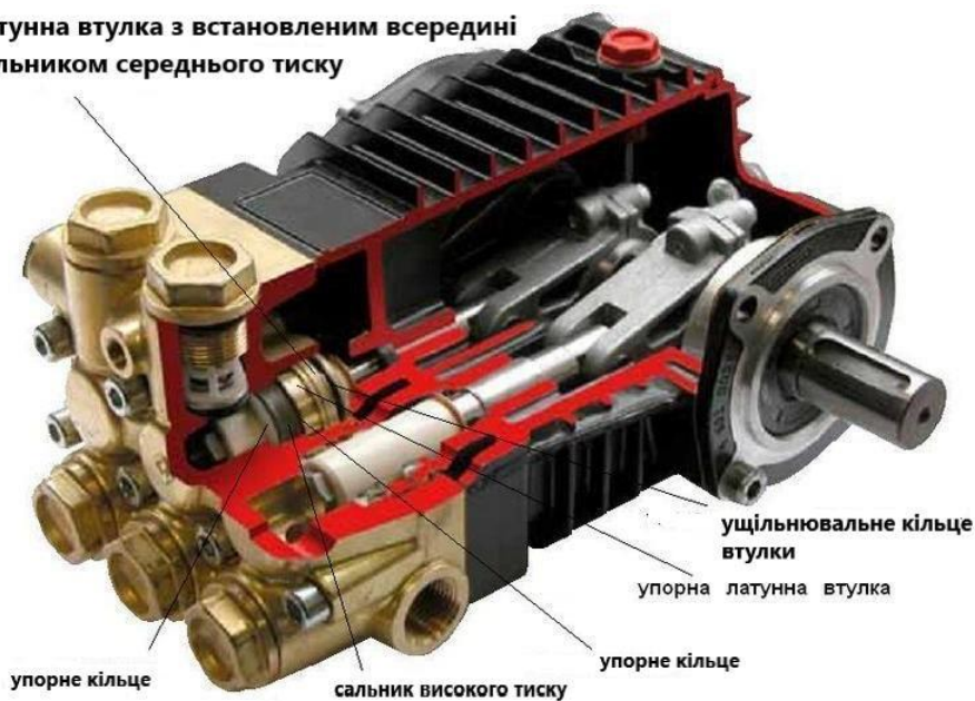
Рис. 2.7 - Конструкції насосів АВТ.
