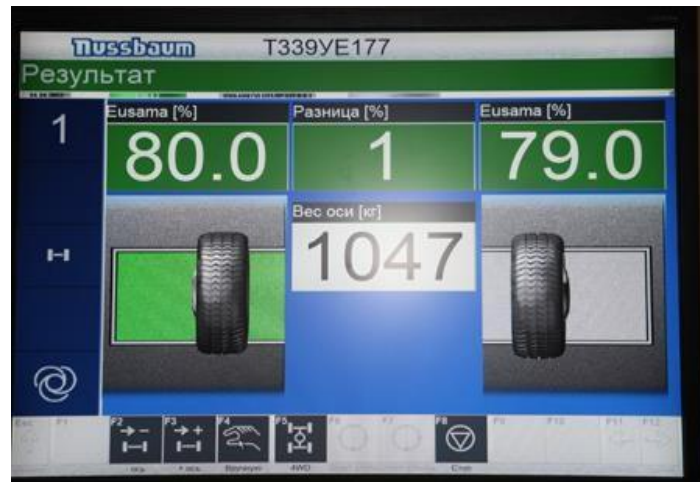
Рис. 5.36 – Результати діагностування за методом EUSAMA.
