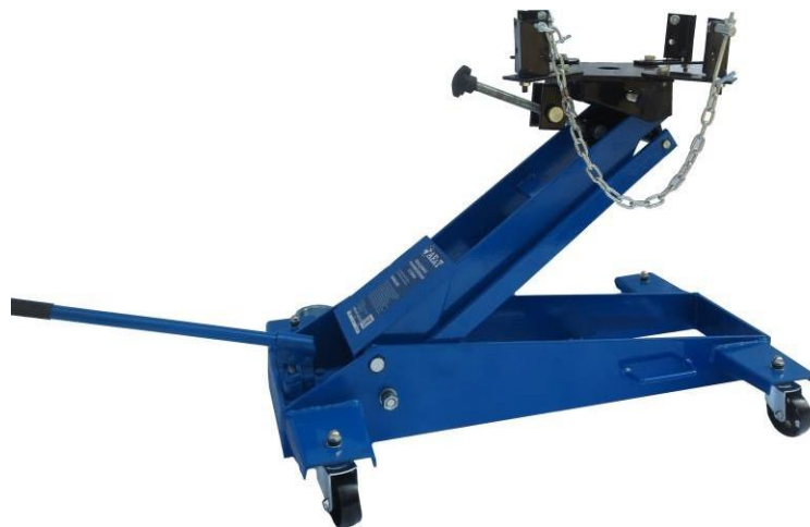
Рис. 3.24 Загальний вид універсального міні-крана для демонтажу- монтажу агрегатів і вузлів вантажних автомобілів.
