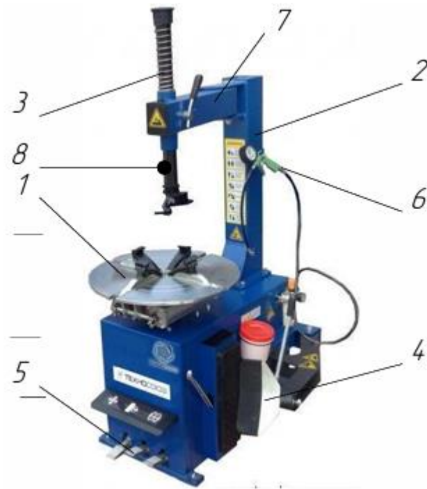
Рис. 6.3 Напівавтоматичний універсальний шиномонтажний стенд для демонтажу-монтажу коліс легкових автомобілів.
