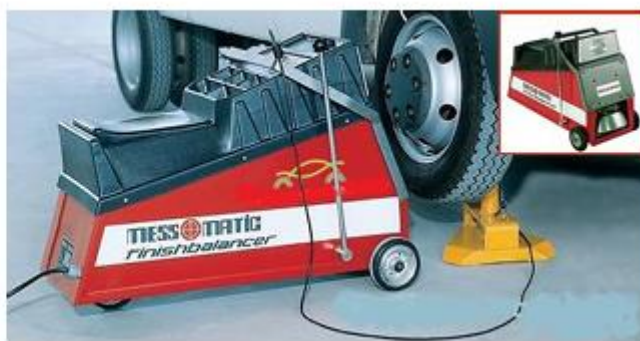
Рис. 6.14 Загальний вигляд стенду балансування коліс на автомобілі.
