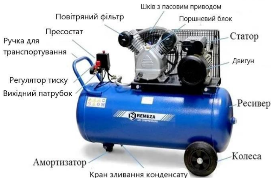
Рисунок 4.27 - Загальна будова поршневого електричного компресора.
