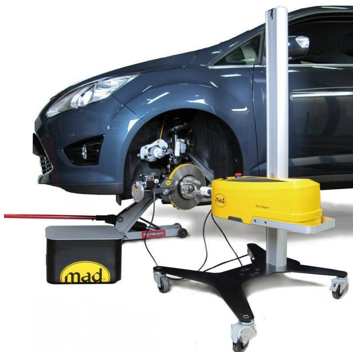
Рис. 7.3 Верстат для двосторонньої проточки гальмівних дисків легкових автомобілів.
