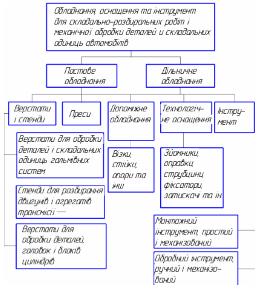
Рис. 7.1 Узагальнена класифікація спеціального обладнання, оснащення і інструмента для проведення складально-розбиральних і слюсарно-механічних робіт на робочих постах і дільницях СТО.
