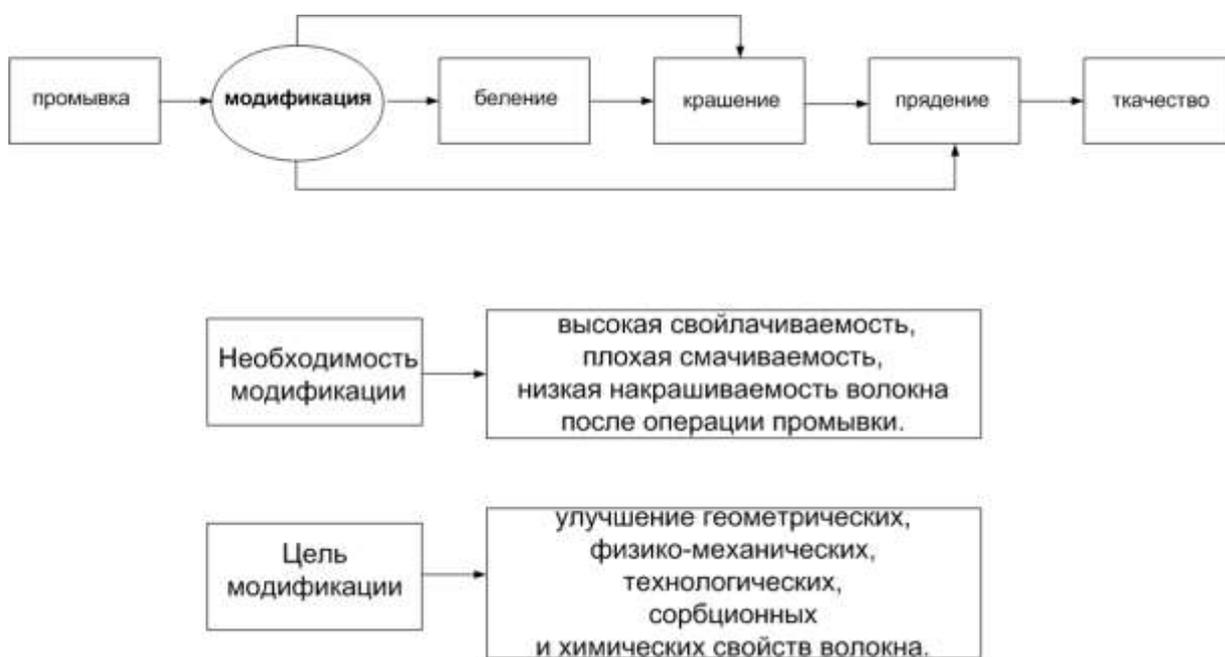
Рис. 1.10. Схема технологии переработки шерстяного волокна
