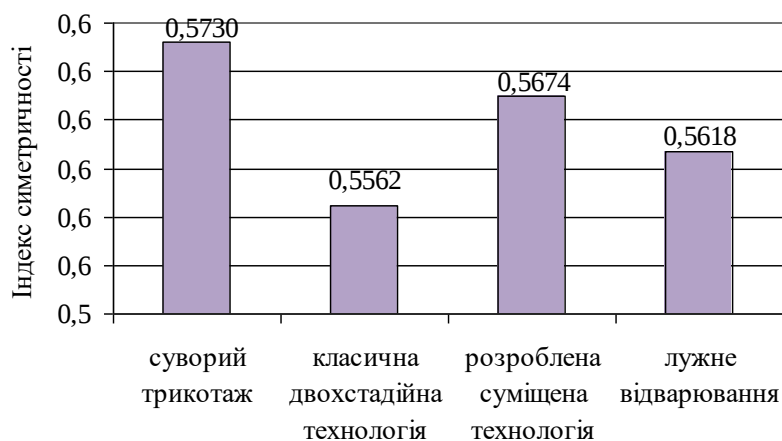
Рис. 4.13. Вплив технології підготовки на індекс симетрії S1_{3800}/S2_{2800} смуги ОН-груп досліджуваних зразків трикотажного полотна.
