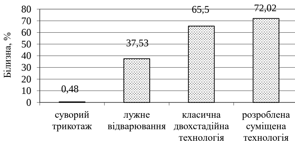
Рис. 4.2. Вплив способу підготовки на білизни бавовняного трикотажу.
