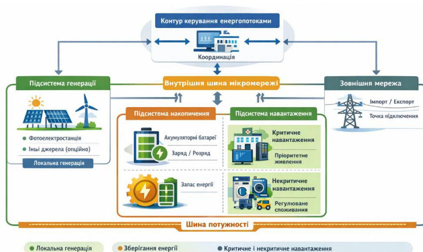
Рисунок 1 – Узагальнена структура досліджуваної гібридної мікромережі
