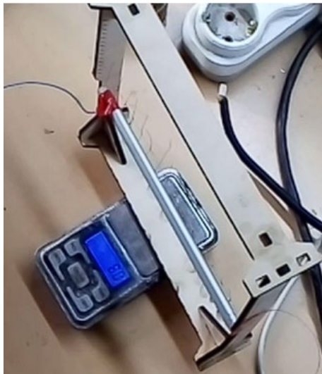
Рисунок 2 – Терези зафіксували тягу 8г (0,079 Н) на тестовому стенді
