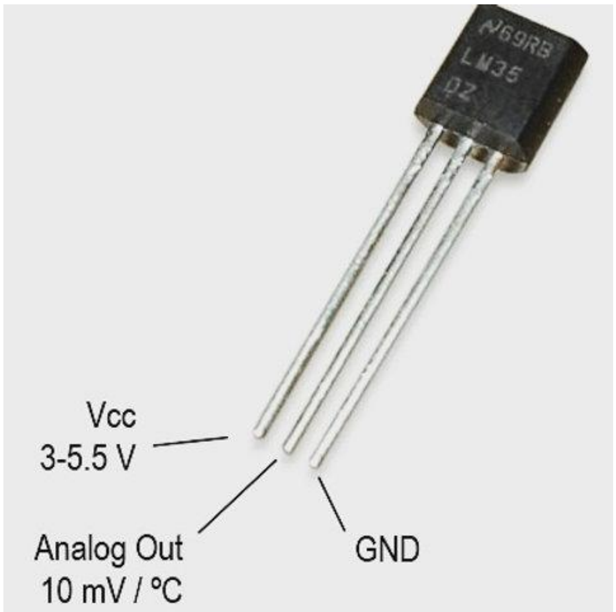
Рисунок 2.6 – Фізичний вигляд датчику температури LM35
