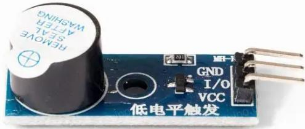
Рисунок 2.3 – Активний п'єзоелектричний динамік (buzzer)
