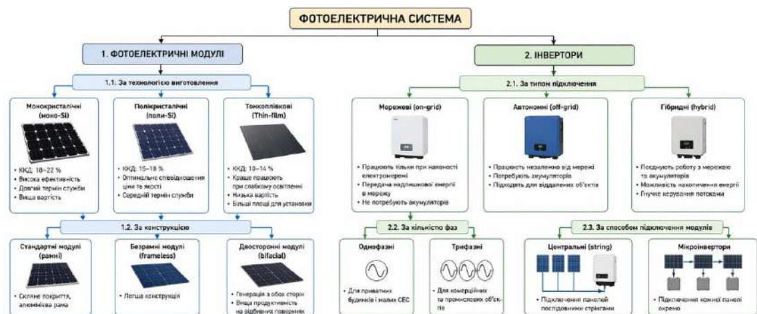
Рисунок 1.2 – Класифікація фотоелектричних модулів та інверторів у структурі фотоелектричної системи
