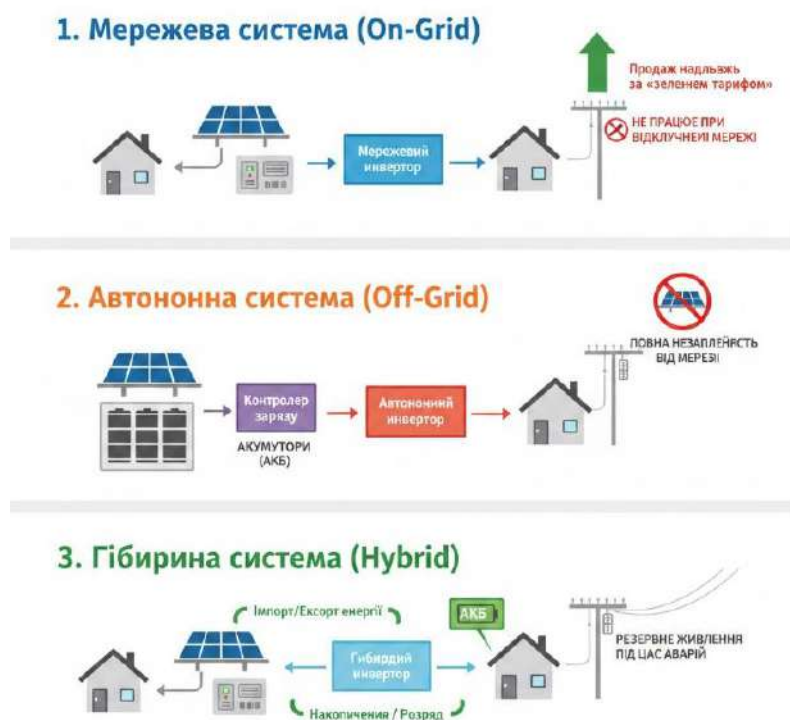
Рисунок 1.3 – Структурні схеми мережевої, автономної та гібридної фотоелектричних установок
