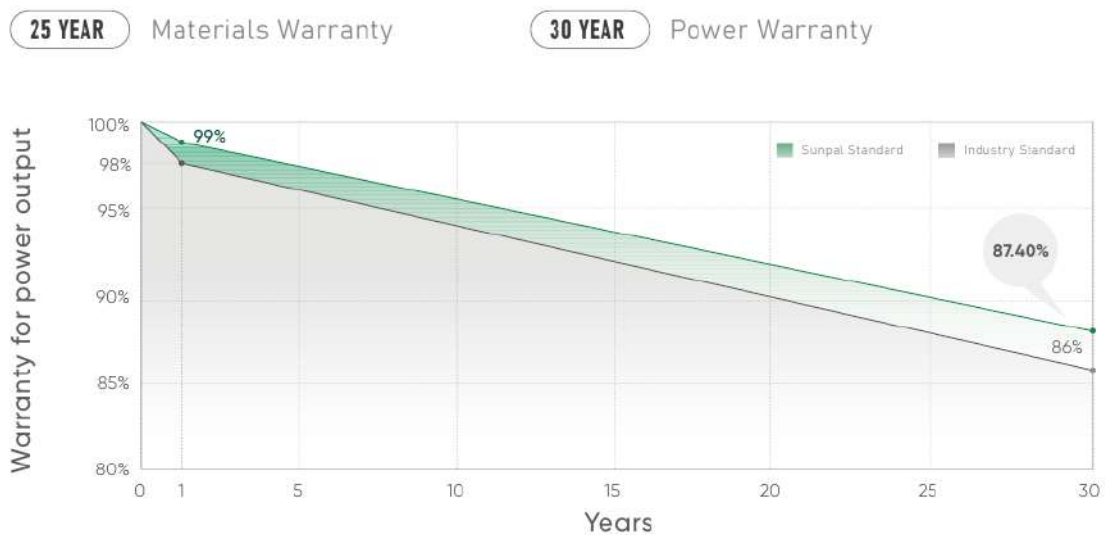
Рисунок 1.4 – Деградація сонячних панелей HiMAX SP640M-78H
