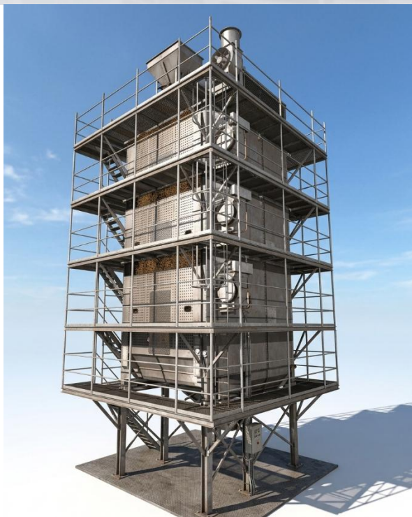
Рисунок 1.2 – Сушарки для гранульованих кормів: а) конвеєрна (горизонтальна); б) вертикальна (баштова)
