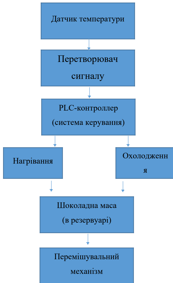
Рис. 4 – Структурна схема автоматизованої системи управління процесом темперування шоколадної маси.
