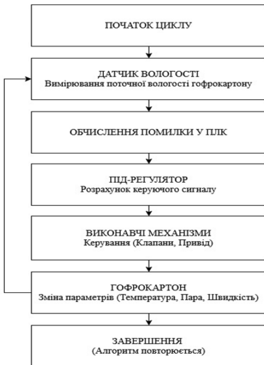
Рисунок 3.12 – Блок-схема алгоритму автоматичного керування вологістю гофрокартону
