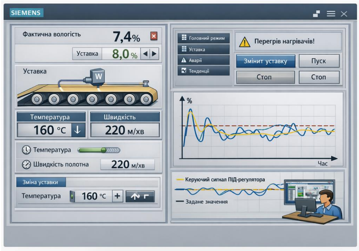
Рис. 3.17 – Людино-машинний інтерфейс системи автоматичного керування вологістю гофрокартону в середовищі WinCC.
