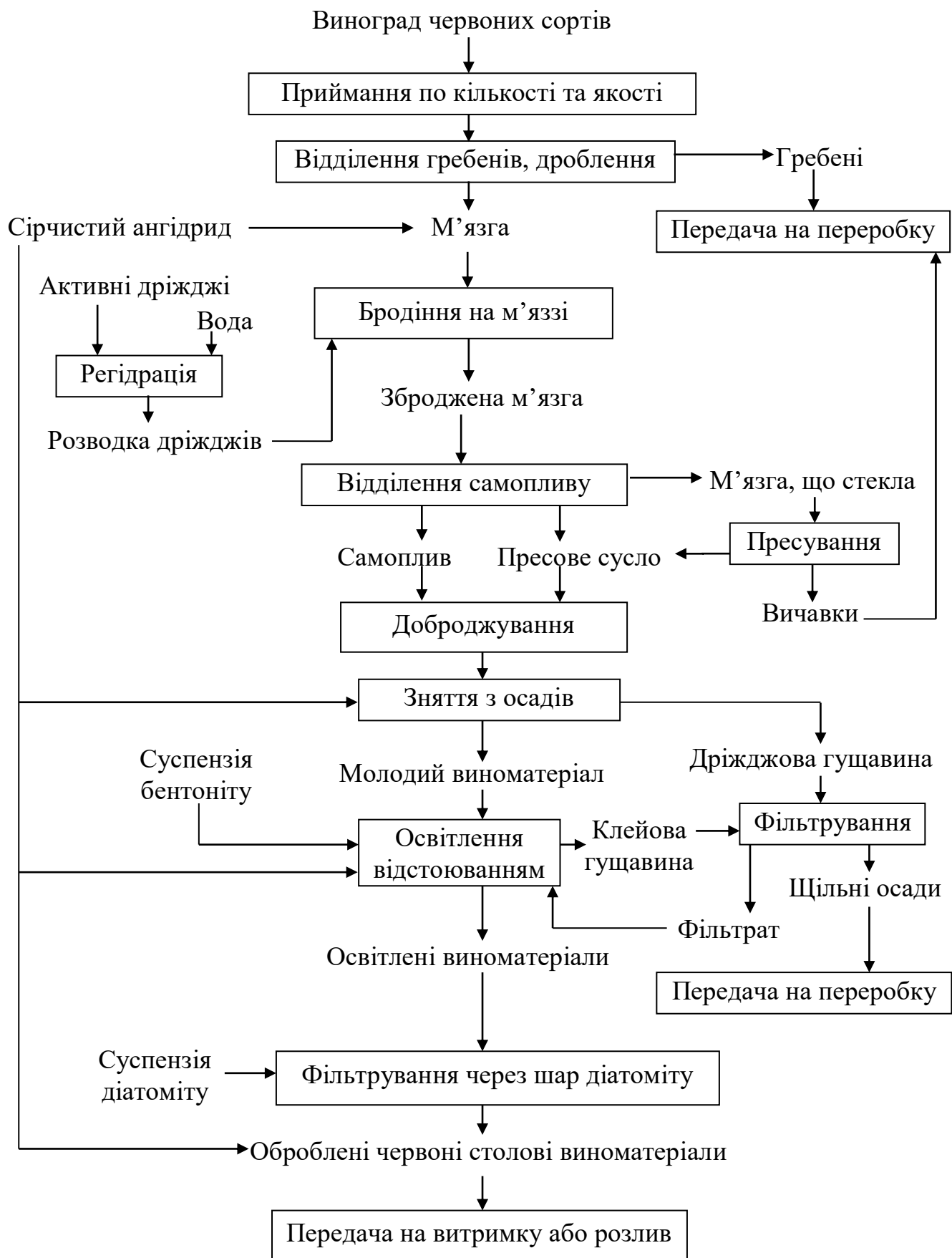
Рисунок 2.2 – Процесуальна технологічна схема переробки червоних сортів винограду з виробництвом сухих столових виноматеріалів
