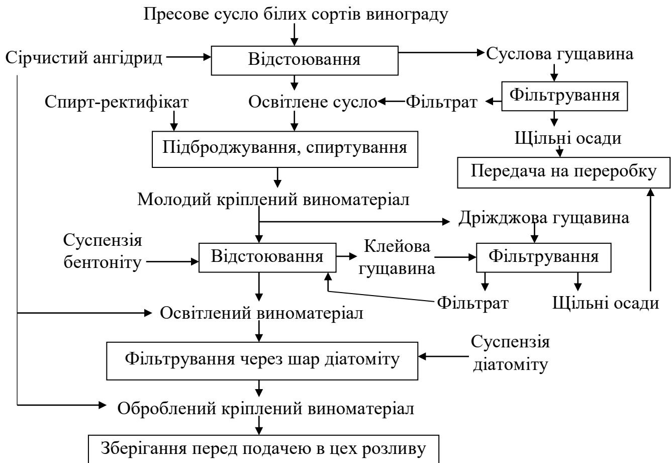
Рисунок 2.3 – Процесуальна схема виробництва кріплених виноматеріалів
