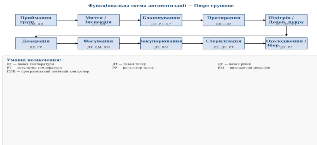
Рисунок 4 — Функціональна схема автоматизації лінії виробництва «Пюре грушового»
