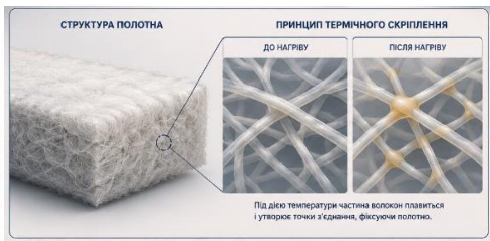
Рисунок 2.2 – Структура синтетичного волокна та принцип його термічного скріплення для отримання утеплювача
