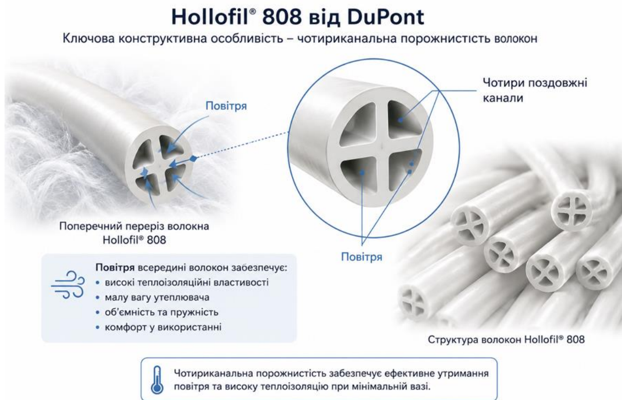
Рисунок 3.3 – Зображення чотирьоканальної порожнистості волокон утеплювача Hollofil® 808 від компанії DuPont
