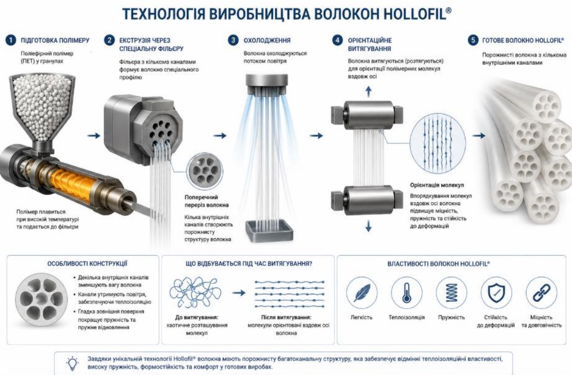
Рисунок 2.3 – Технологія виробництва волокон Hollofil® 808
