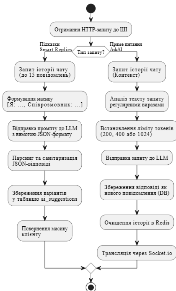
Рисунок 2.5 – Блок-схема (Activity Diagram) алгоритму взаємодії системи з API мовної моделі
