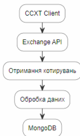
Рисунок 2.2. Схема роботи модуля збору даних
