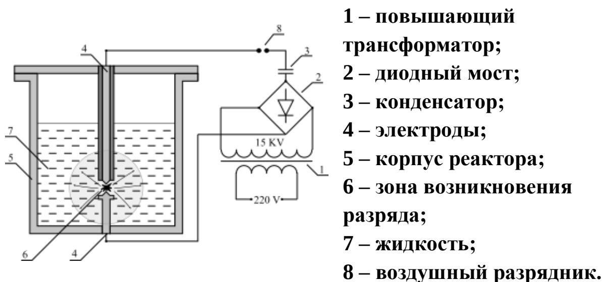
Рис. 2.1. Схема лабораторной установки для электроразрядной обработки «Вега-6».
