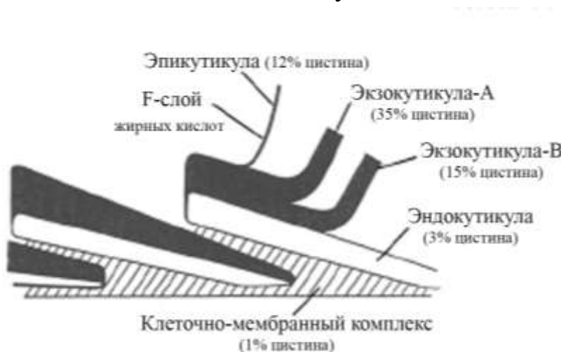
Рис. 3.4. Схема строения кутикулы шерстяного волокна.
